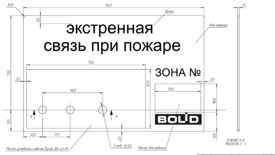
Рисунок 2.2.5 – Габаритные и установочные размеры информационной подложки абонентской вызывной панели «Рупор-ДА исп.01».
