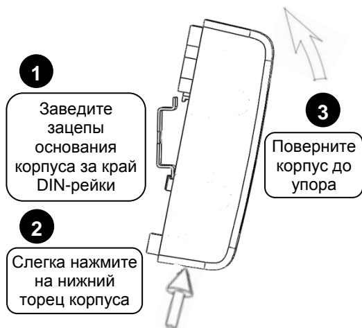
Рисунок 3. Крепление блока на DIN-рейку
