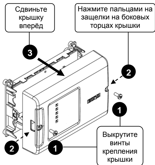
Рисунок 2. Снятие крышки AP8
