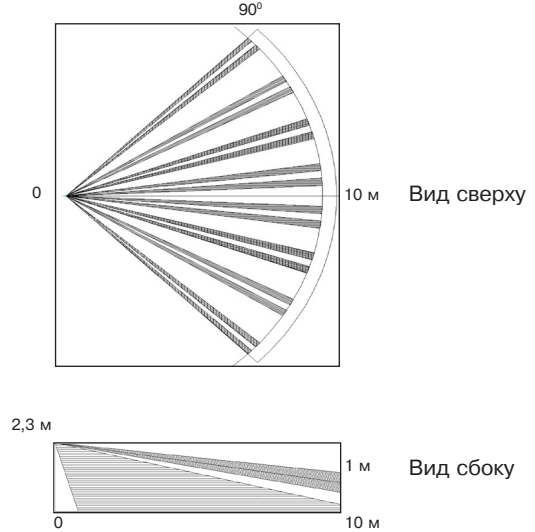
Рисунок 1 – Диаграмма зоны обнаружения извещателя «С2000-ИК» исп.02
