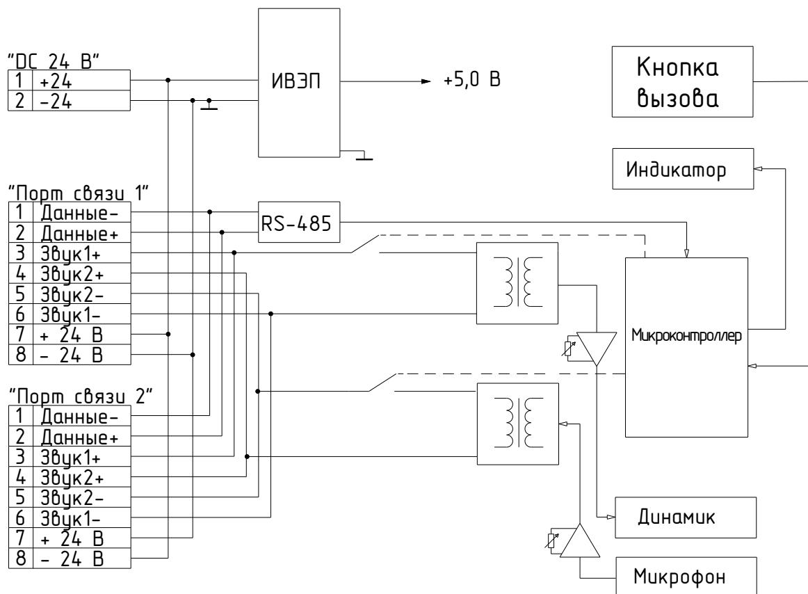
**Рисунок В — Функциональная схема ВП ROXTON CP-8032 и CP-8032i**
