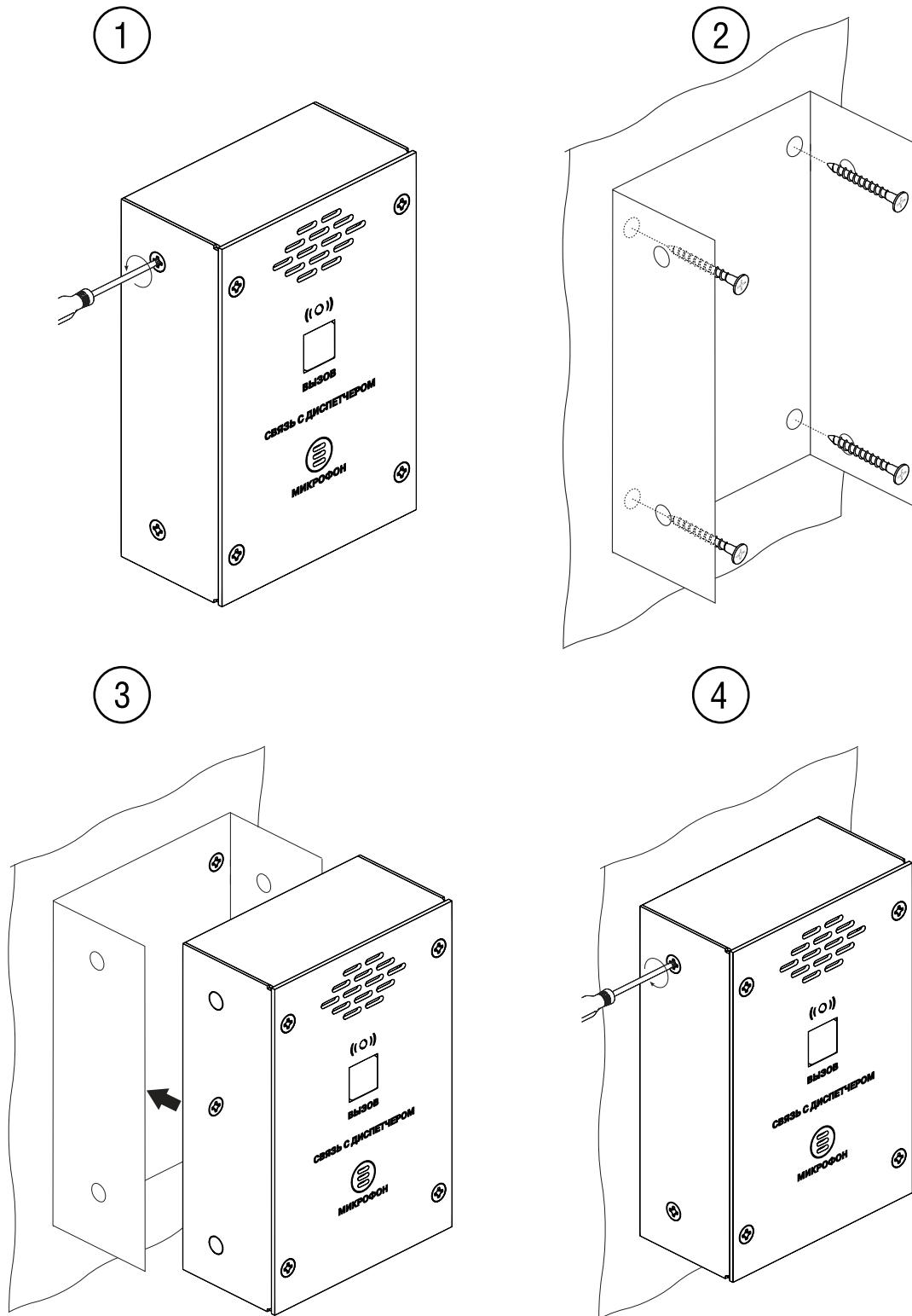
**Рисунок Г — Схема монтажа изделия ROXTON CP-8032**
