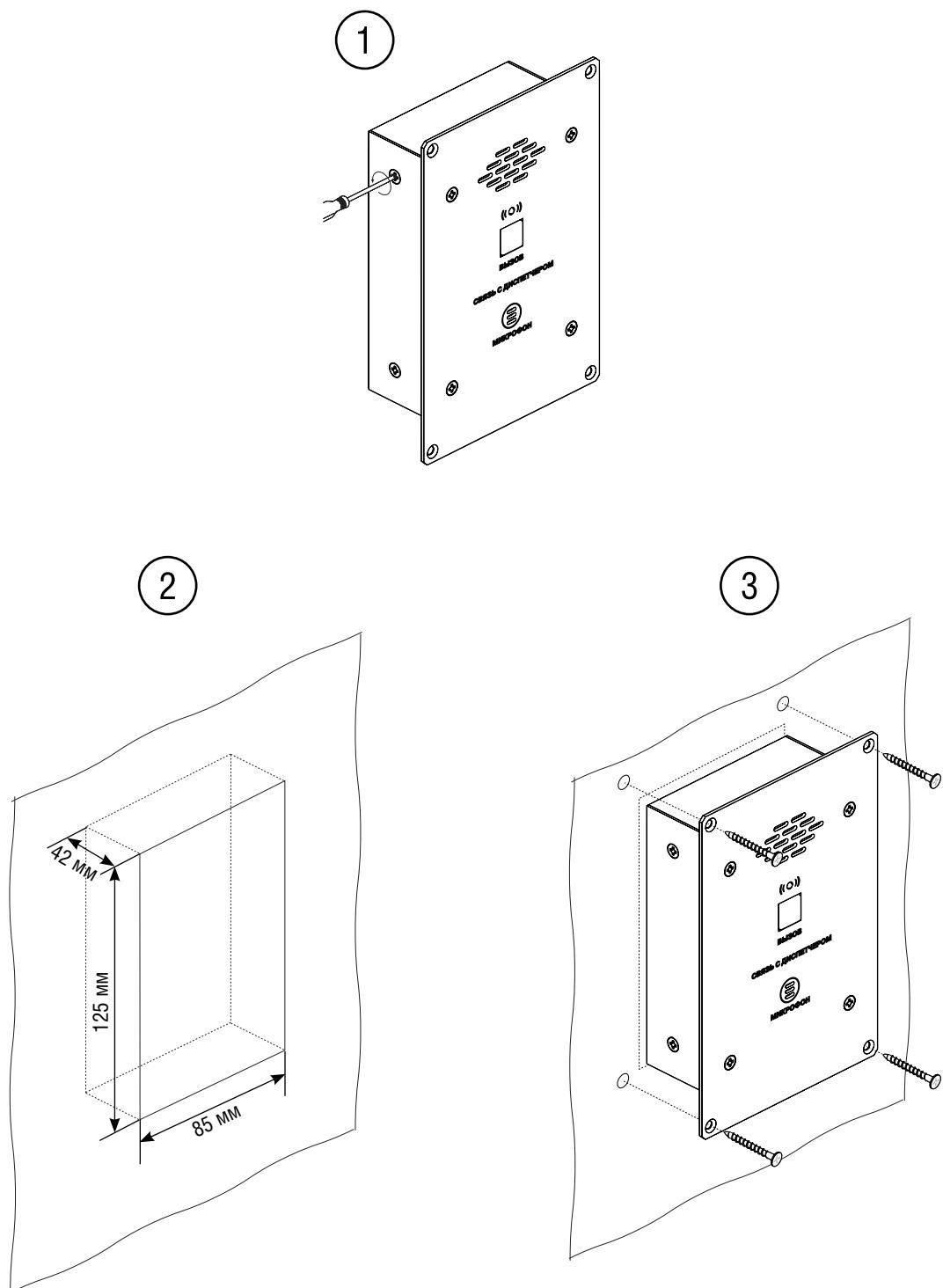
**Рисунок Д — Схема монтажа изделия ROXTON CP-8032i**
