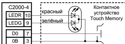
**Рисунок 14. Схема подключения контактного устройства Touch Memory**
