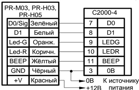
**Рисунок 18.** Схема подключения считывателей PR-M03, PR-H03, PR-H05
