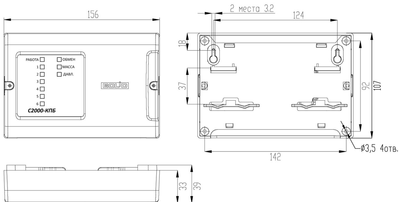
Рисунок 2.2.1 – Внешний вид и габаритно-установочные размеры блока.
