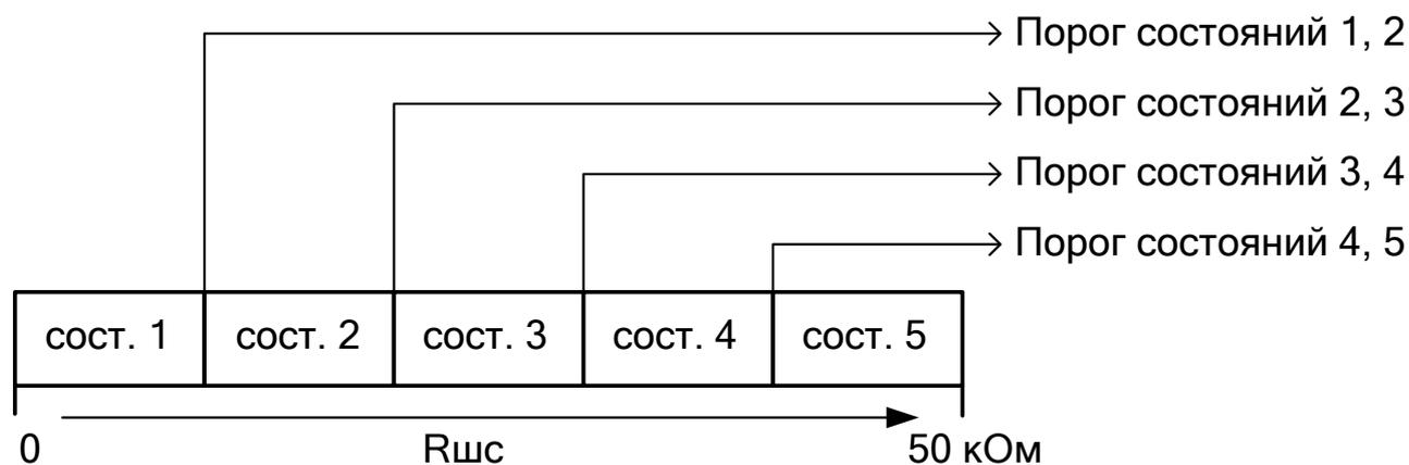
**Рисунок 1.4.1** Состояния и пороги переходов между состояниями входа.
