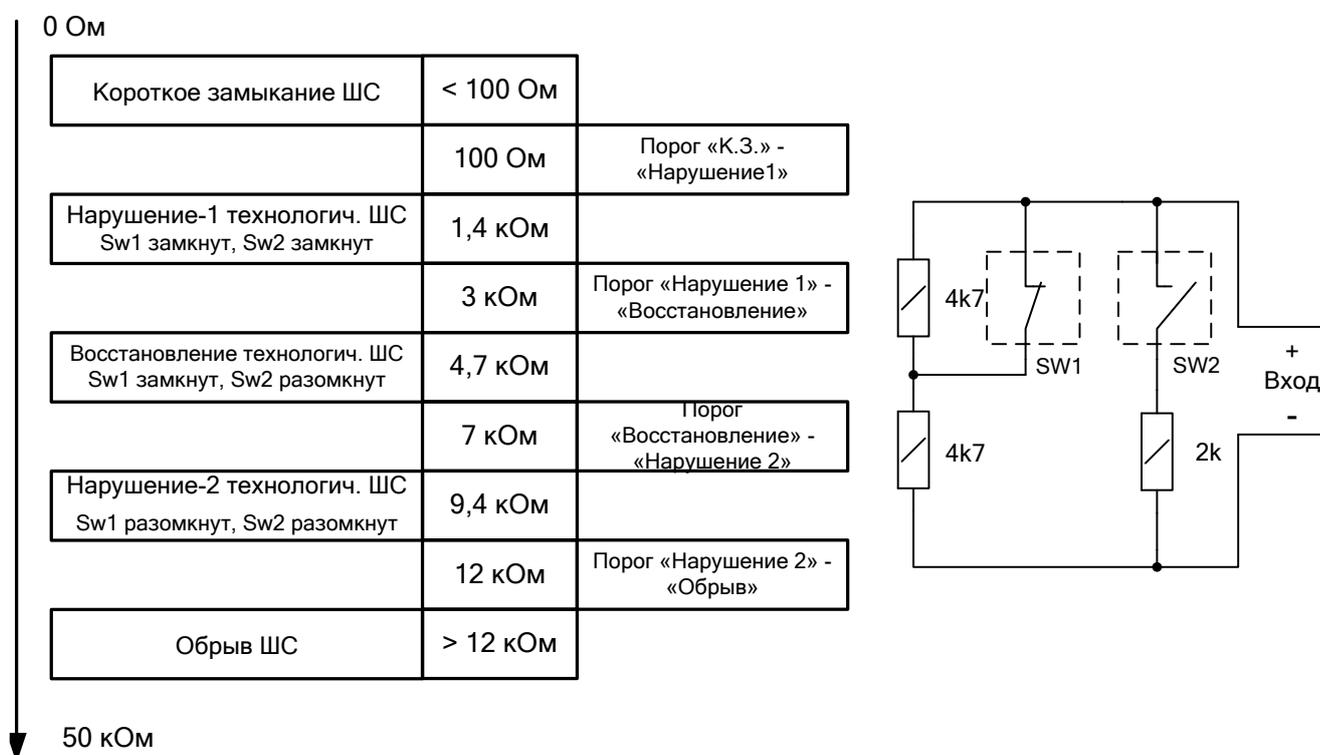
Рисунок 1.4.2. Пример параметров входа и схемы ШС.
