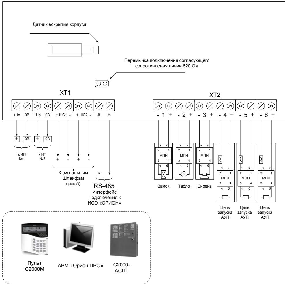
ИП №1, №2 – основной и резервный источники питания постоянного тока с напряжением от +12 до +24 В
