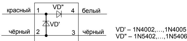
Рисунок 4. Схема внешних соединений блока
