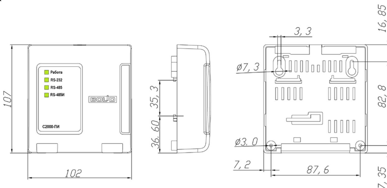
Рисунок 1. Внешний вид, габаритные и установочные размеры
