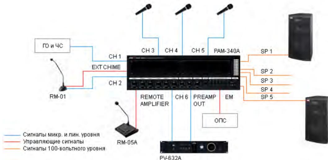
Система музыкальной трансляции и оповещения построена на основе микшер-усилителя PAM-340A с подключенным модулем PAM-VF. Система имеет 5 зон общей мощностью 340 Вт.
