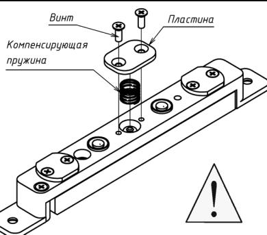
Рисунок 4 – Демонтаж пружины якоря
