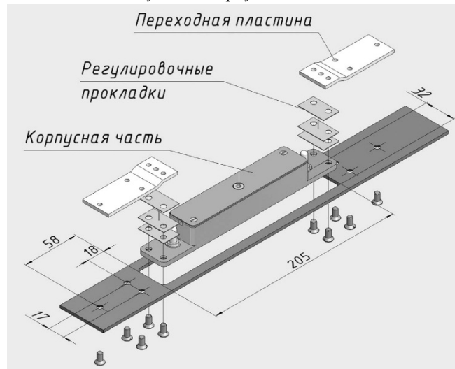
Рисунок 6 - Установка корпуса замка в металлическую коробку
