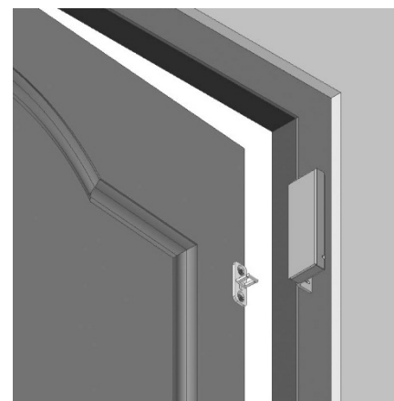
Рисунок 3- Установка замка на монтажный L-уголок
