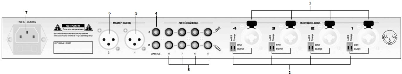
1. «Микрофонный вход 1-4» - Предназначен для подключения динамических или конденсаторных микрофонов. (Комбинированный разъем XLR и JACK).
