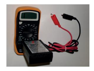
MFL-92 состоит из двух блоков: FDG-92 - генератор тонального сигнала и поискового прибора FDR-92. Данный комплект позволяет определить точку неисправности (точку срабатывания) без разрушения линий термокабеля на участке протяженностью до 3000м. Для поиска неисправности генератор тона FDG-92 подключается к шлейфу термокабеля с помощью клеммных зажимов «крокодил» и выдает в линию термокабеля тональный сигнал. Контроль точки срабатывания осуществляется приемником FDR-92 по звуковому сигналу.
