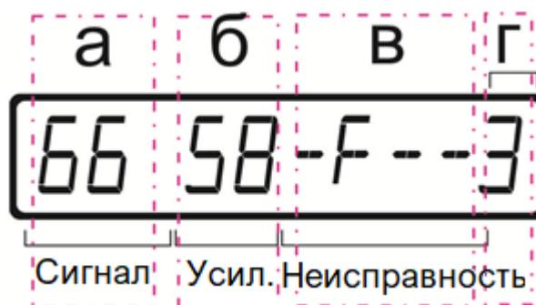
Рисунок 2.3 - Отображение информации на дисплее прибора контроля в режиме «Прием с ВУОС»
