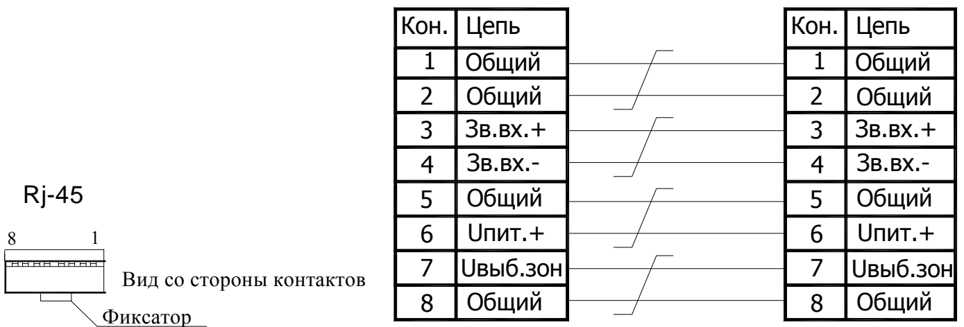
Рис.2 Схема соединения кабеля Нумерация контактов разъема Rj-45 условная.
