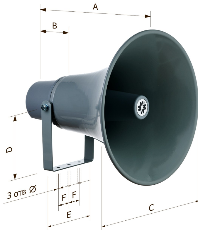
Рис. 7 Габаритные и установочные размеры громкоговорителей
