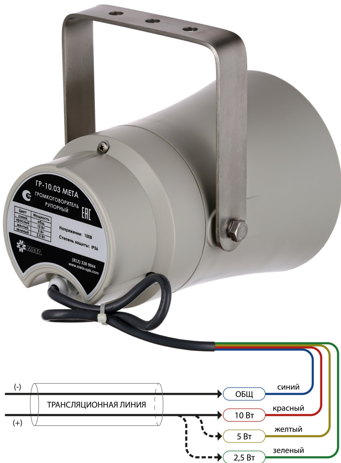
Рис.3 Схемы подключения ГР к трансляционной линии.
