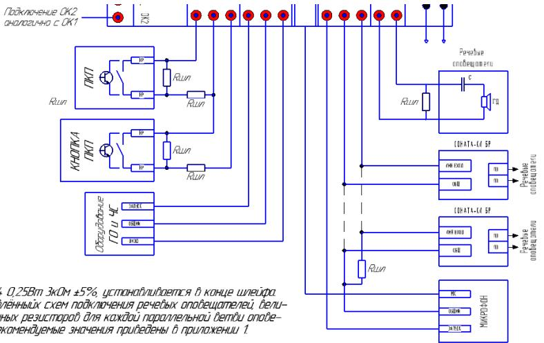
\*R100 – резистор типа С1-4 0,25Вт 3кОм ±5% устанавливается в конце шлейфа. При использовании разветвлённых схем подключения речевых оповещателей величина сопротивления оконечных резисторов для каждой параллельной линии оповещателей изменяется, их рекомендуемые значения приведены в приложении 1.
