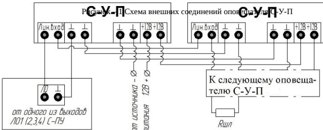
Rшл – резистор типа С1-4, 0,25Вт ЭЖм ±5%, устанавливается в конце шлейфа (идёт в комплекте поставки с прибором С-ПУ).
