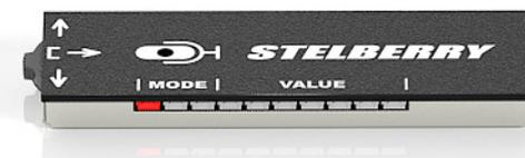
В этом режиме можно ослабить низкие частоты до 20 дБ ( до 10 раз), вплоть до 564 Гц. Для входа в режим необходимо нажать на джойстик, чтобы в индикации режима MODE появилась следующая комбинация ●○○
