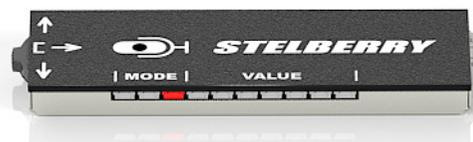
В этом режиме можно отрегулировать чувствительность микрофона. Для входа в режим необходимо нажать на джойстик, чтобы в индикации режима MODE появилась следующая комбинация ○○●
