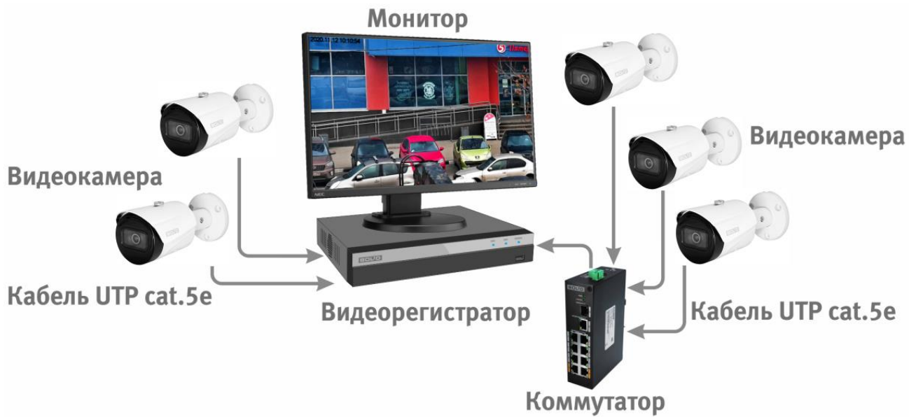
Рисунок 6.4 — Схема подключения видеокамеры к видеорегистратору
