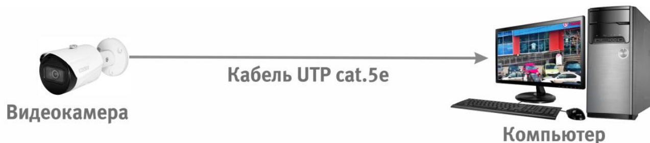
Рисунок 6.2 — Схема подключения видеокамеры к компьютеру
