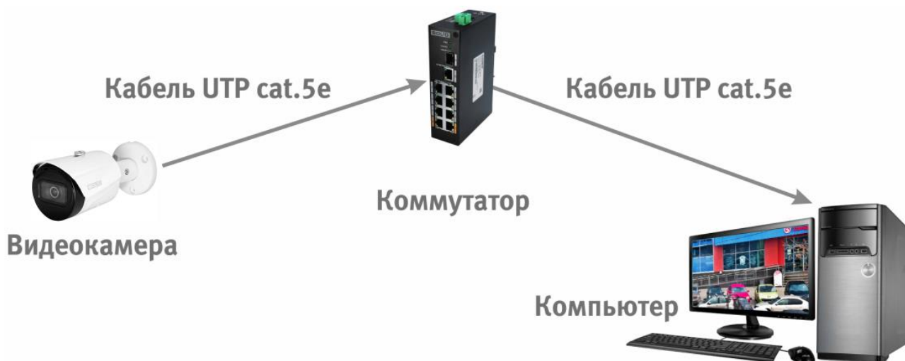
Рисунок 6.3 — Схема подключения видеокамеры к компьютеру через коммутатор
