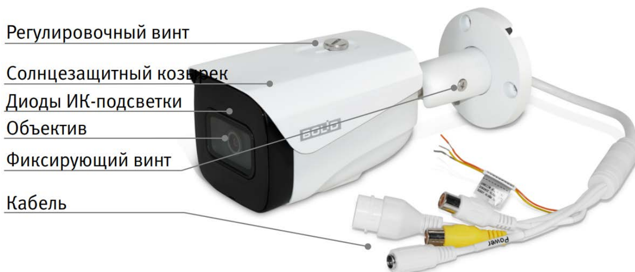
Рисунок 4.1 — Внешний вид и основные элементы видеокамеры
