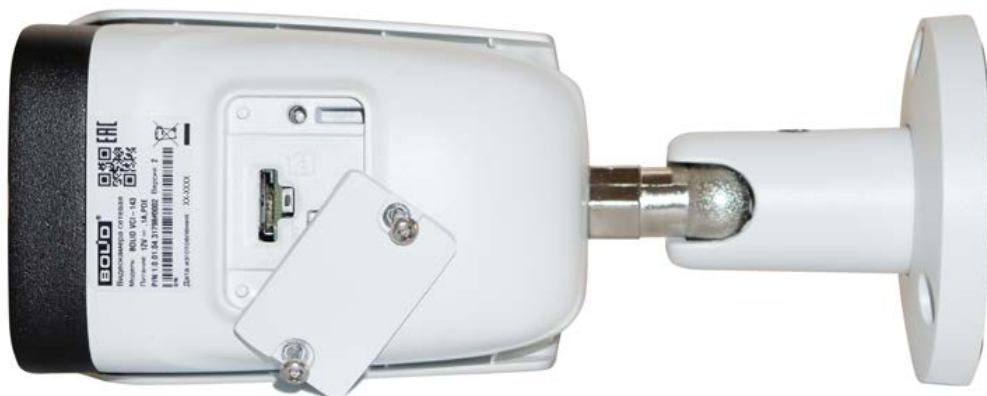
Рисунок 4.2 — Расположение кнопки аппаратного сброса и слота для карты памяти
