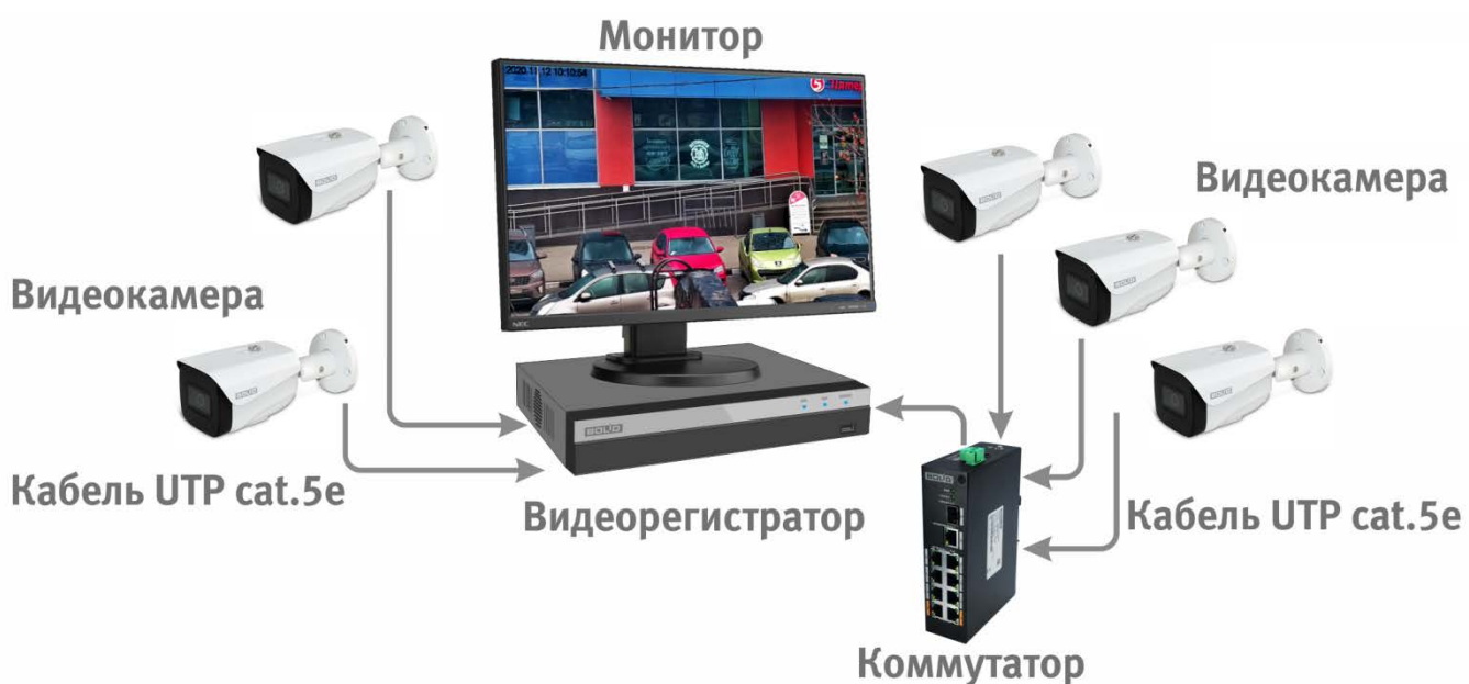
Рисунок 6.4 — Схема подключения видеокamer к видеорегистратору
