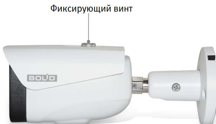
Рисунок 5.14 — Настройка направления объектива
