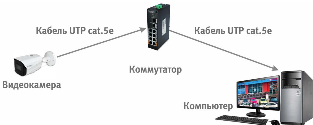
Рисунок 6.3 — Схема подключения видеокамеры к компьютеру через коммутатор
