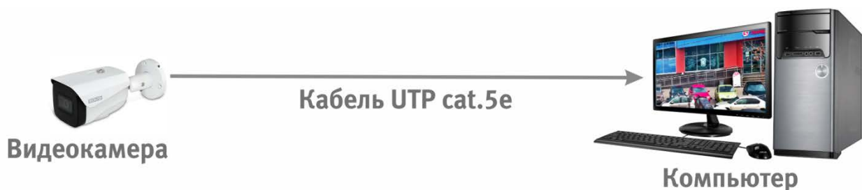
Рисунок 6.2 — Схема подключения видеокамеры к компьютеру
