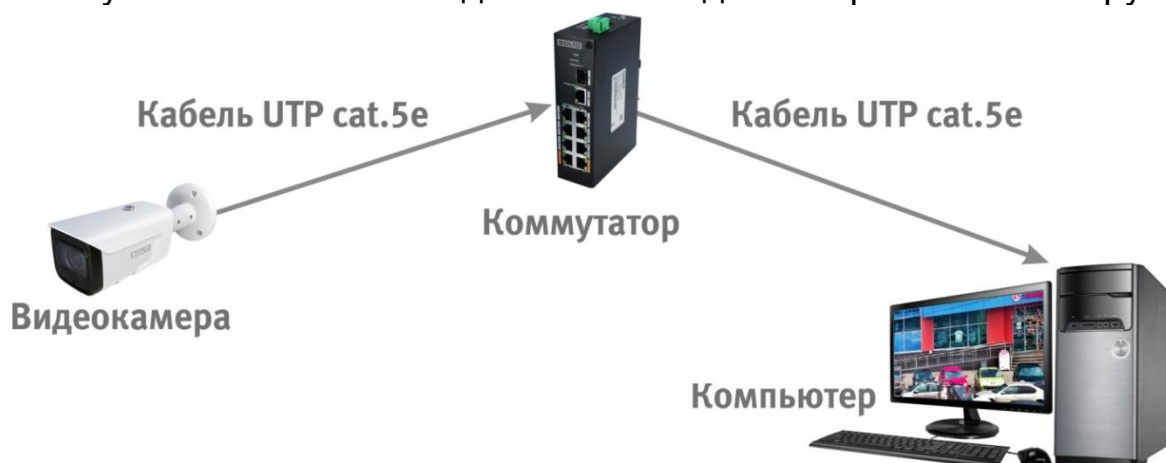
Рисунок 6.3 — Схема подключения видеокамеры к компьютеру через коммутатор
