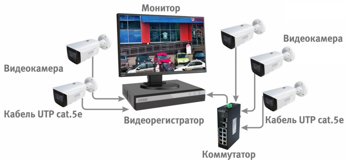
Рисунок 6.4 — Схема подключения видеокамеры к видеорегистратору
