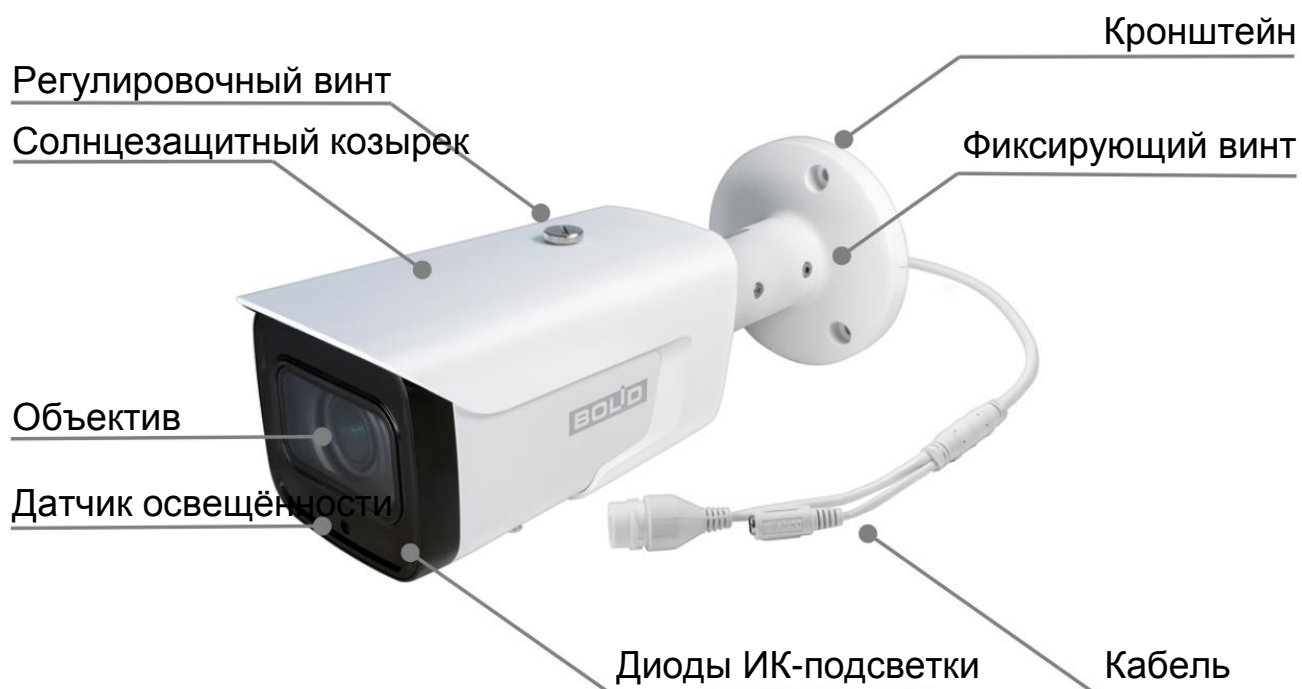
Рисунок 4.1 — Внешний вид и основные элементы видеокамеры
