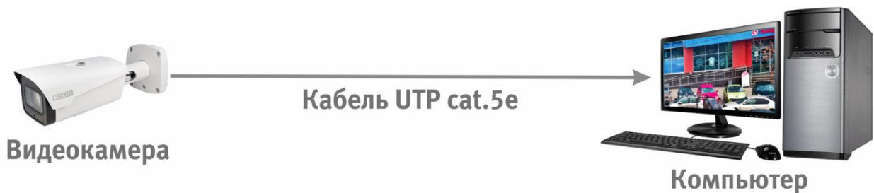
Рисунок 6.3 — Схема подключения видеокамеры к компьютеру
