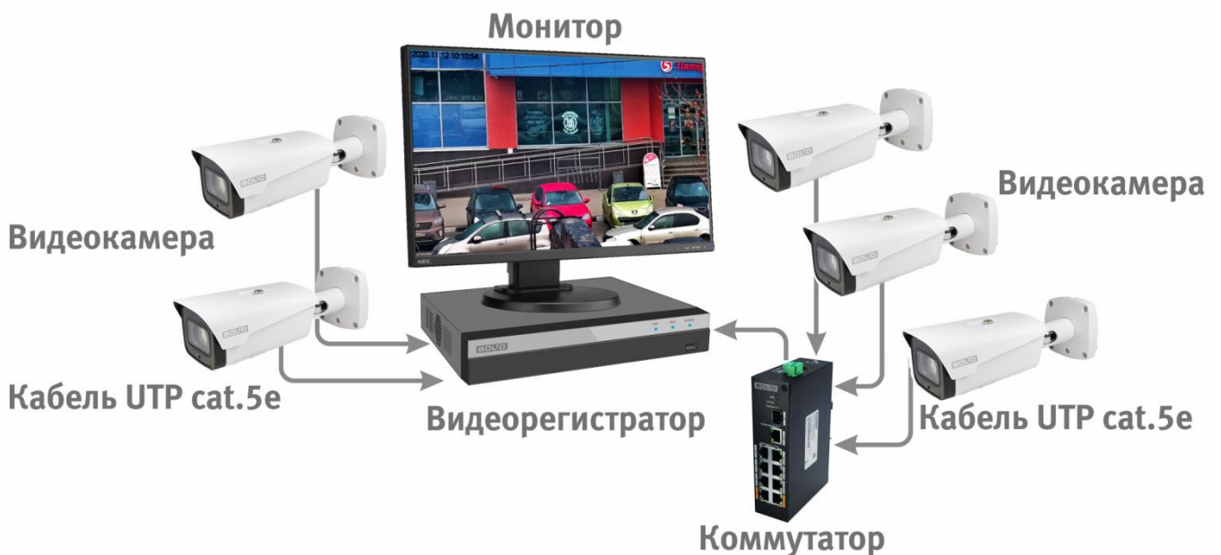
Рисунок 6.5 — Схема подключения видеокамеры к видеорегистратору
