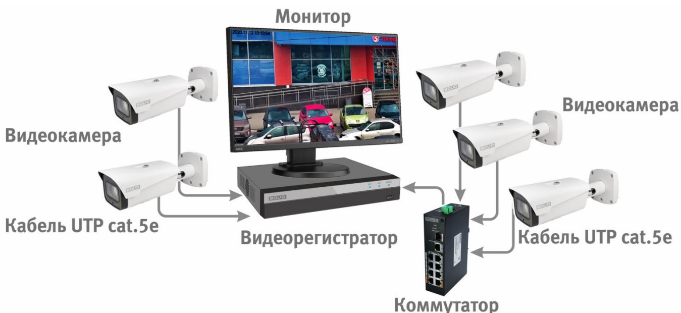
Рисунок 6.5 — Схема подключения видеокамеры к видеорегистратору
