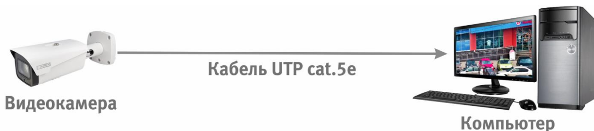
Рисунок 6.3 — Схема подключения видеокамеры к компьютеру
