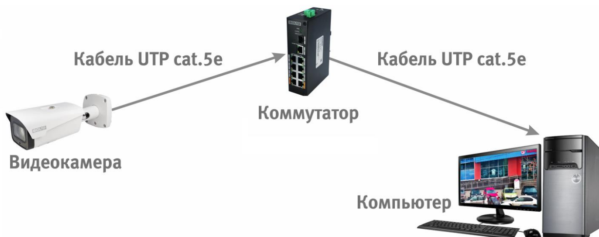
Рисунок 6.4 — Схема подключения видеокамеры к компьютеру через коммутатор
