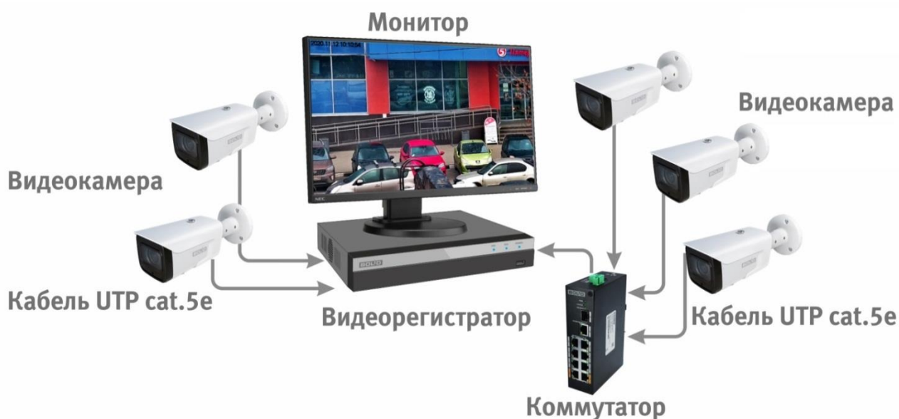
Рисунок 6.4 — Схема подключения видеокamеры к видеорегистратору
