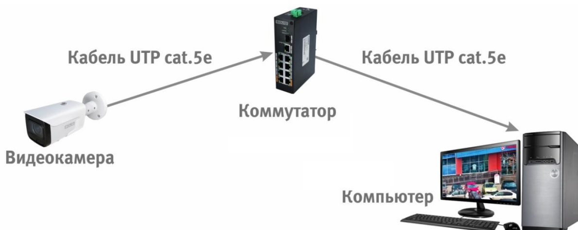
Рисунок 6.3 — Схема подключения видеокамеры к компьютеру через коммутатор
