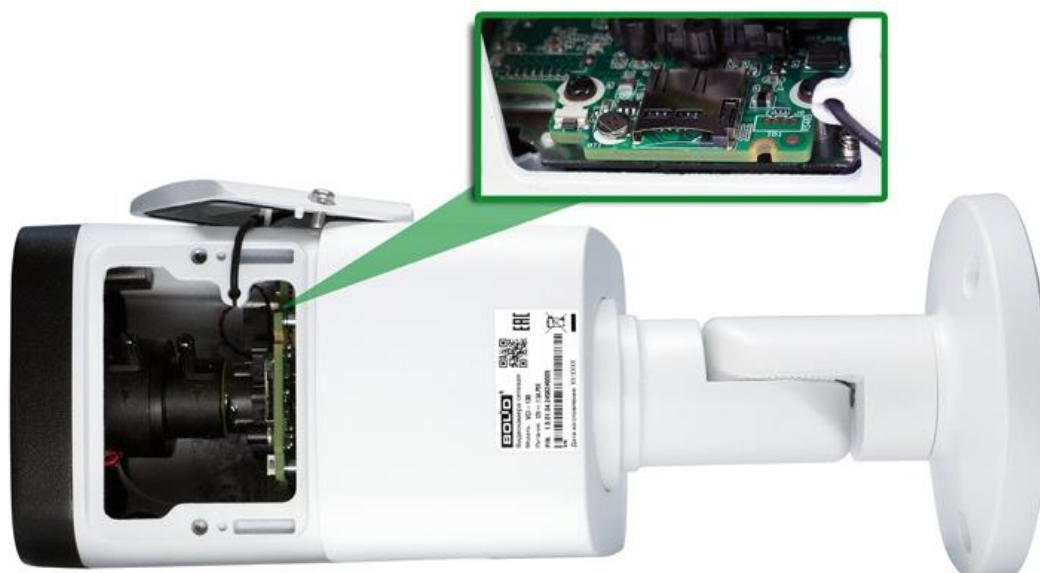
Рисунок 4.2 — Расположение кнопки аппаратного сброса и слота для карты памяти
