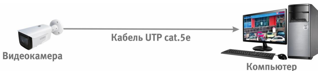
Рисунок 6.2 — Схема подключения видеокамеры к компьютеру
