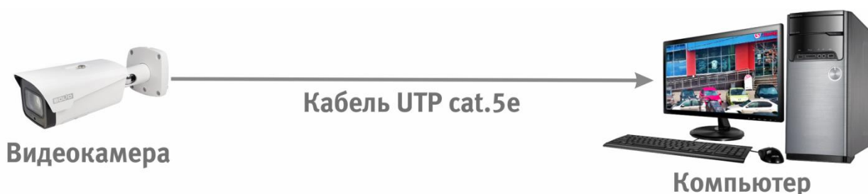
Рисунок 6.3 — Схема подключения видеокамеры к компьютеру
