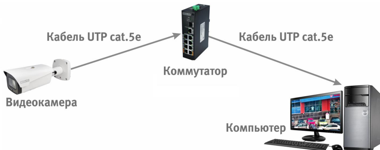
Рисунок 6.4 — Схема подключения видеокамеры к компьютеру через коммутатор
