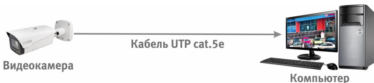
Рисунок 6.3 — Схема подключения видеокамеры к компьютеру
