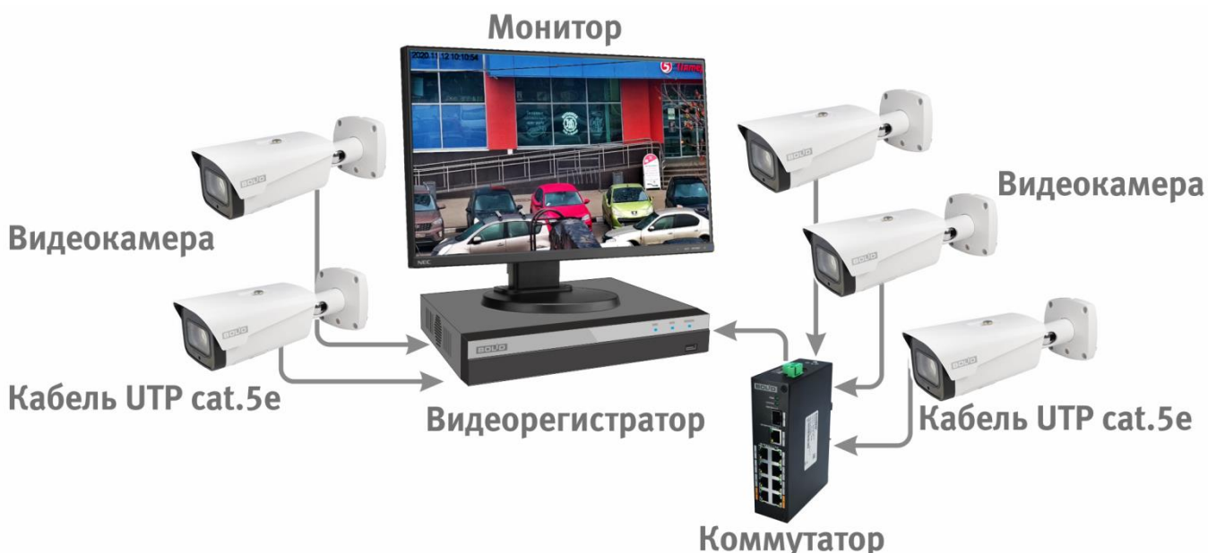
Рисунок 6.5 — Схема подключения видеокамеры к видеорегистратору
