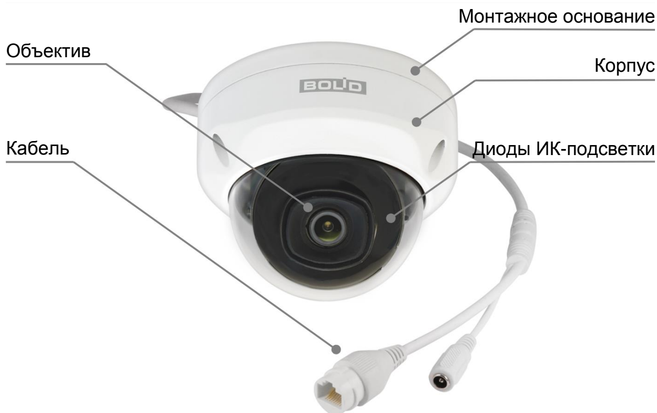
Рисунок 4.1 — Внешний вид и основные элементы видеокамеры
