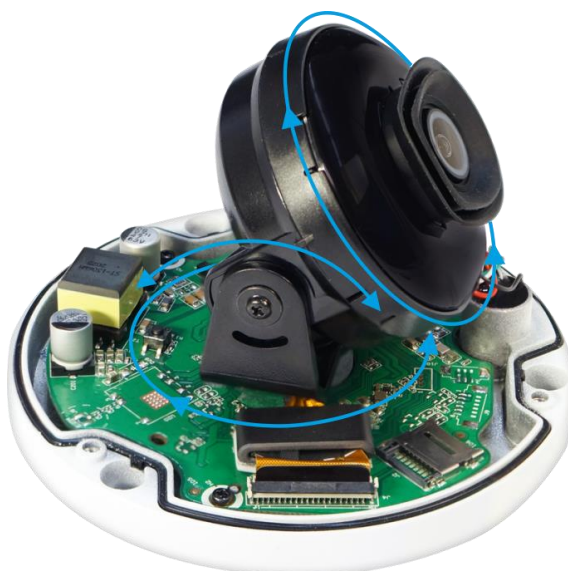
Рисунок 5.7 — Настройка направления объектива
