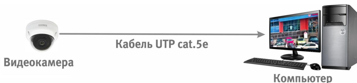
Рисунок 6.2 — Схема подключения видеокамеры к компьютеру
