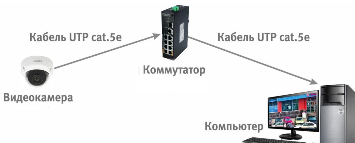
Рисунок 6.3 — Схема подключения видеокамеры к компьютеру через коммутатор
