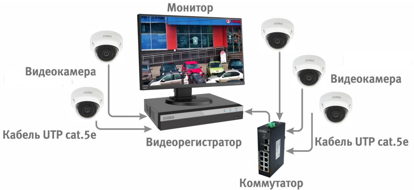
Рисунок 6.4 — Схема подключения видеокамеры к видеорегистратору
