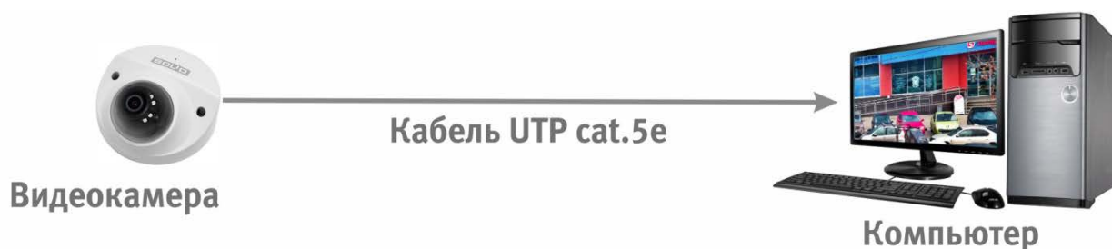
Рисунок 6.2 — Схема подключения видеокамеры к компьютеру
