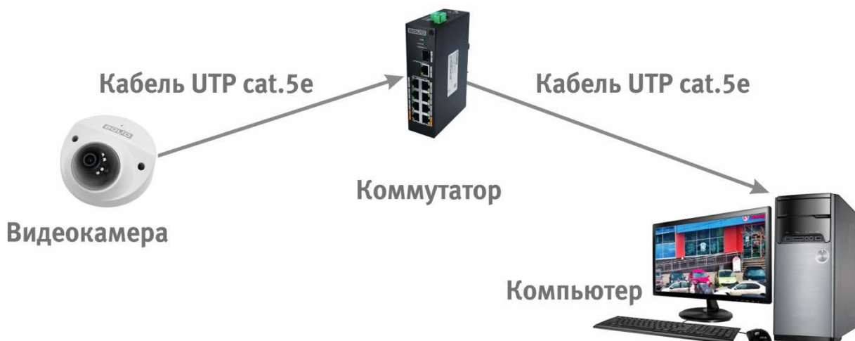
Рисунок 6.3 — Схема подключения видеокамеры к компьютеру через коммутатор
