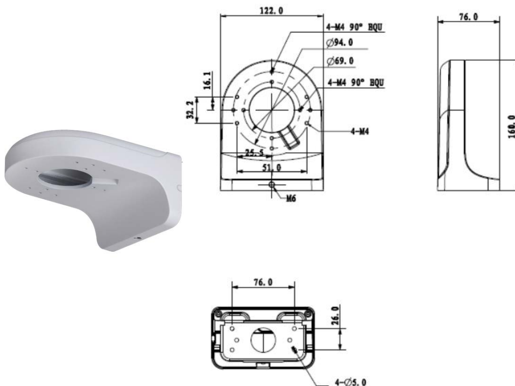
Рисунок 5.4 — Внешний вид и габаритные размеры кронштейна BR-105
