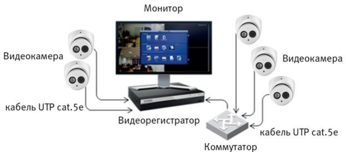
Рисунок 6.4 – Схема подключения видеокамеры к видеорегистратору
