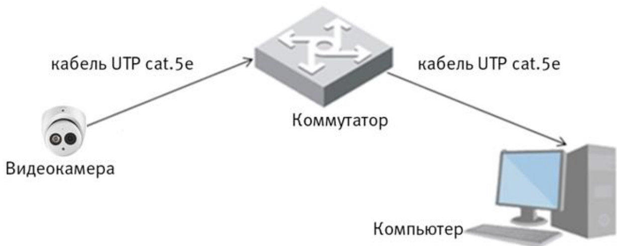
Рисунок 6.3 - Схема подключения видеокамеры к компьютеру через коммутатор
