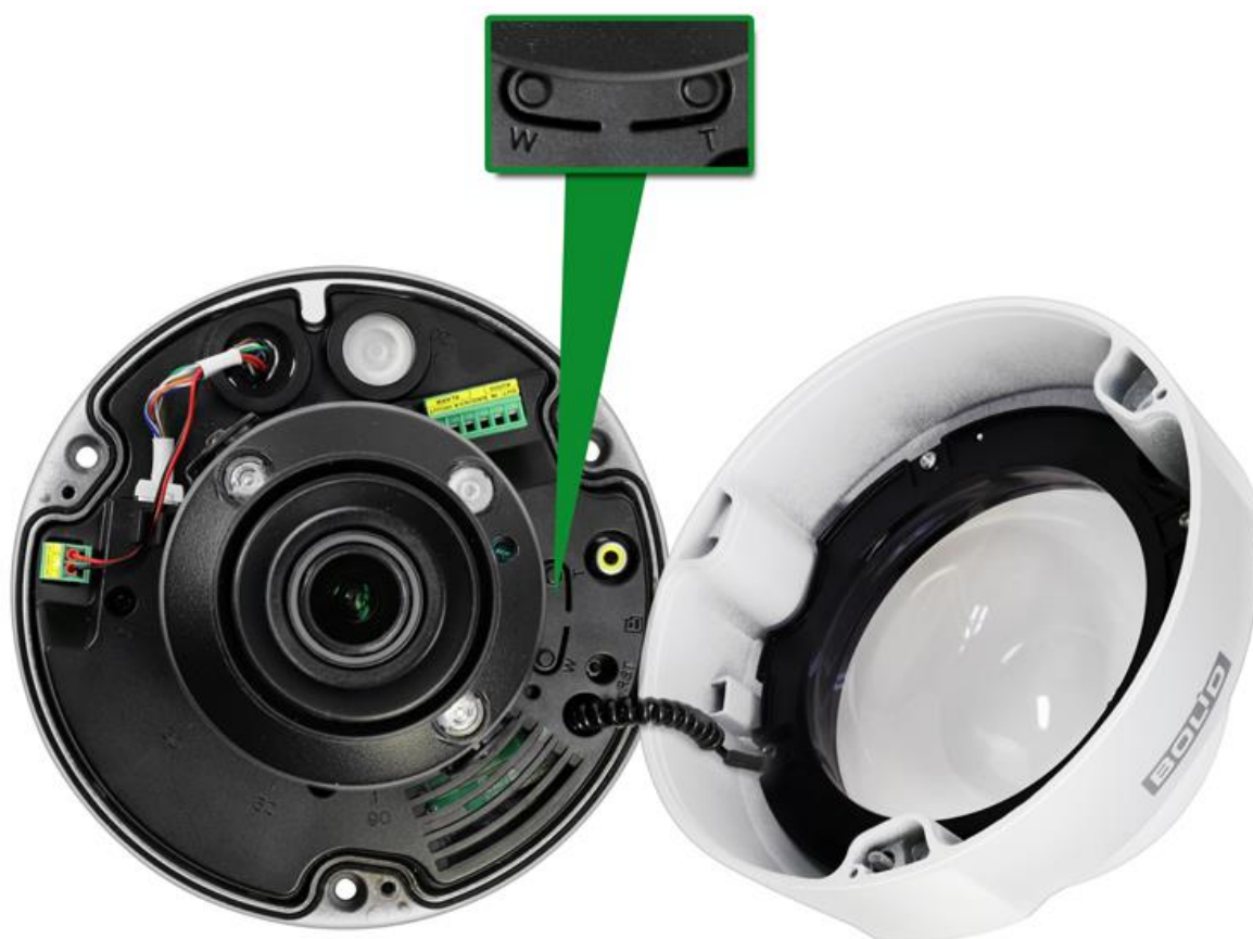
Рисунок 5.15 – Настройка фокусного расстояния вручную
