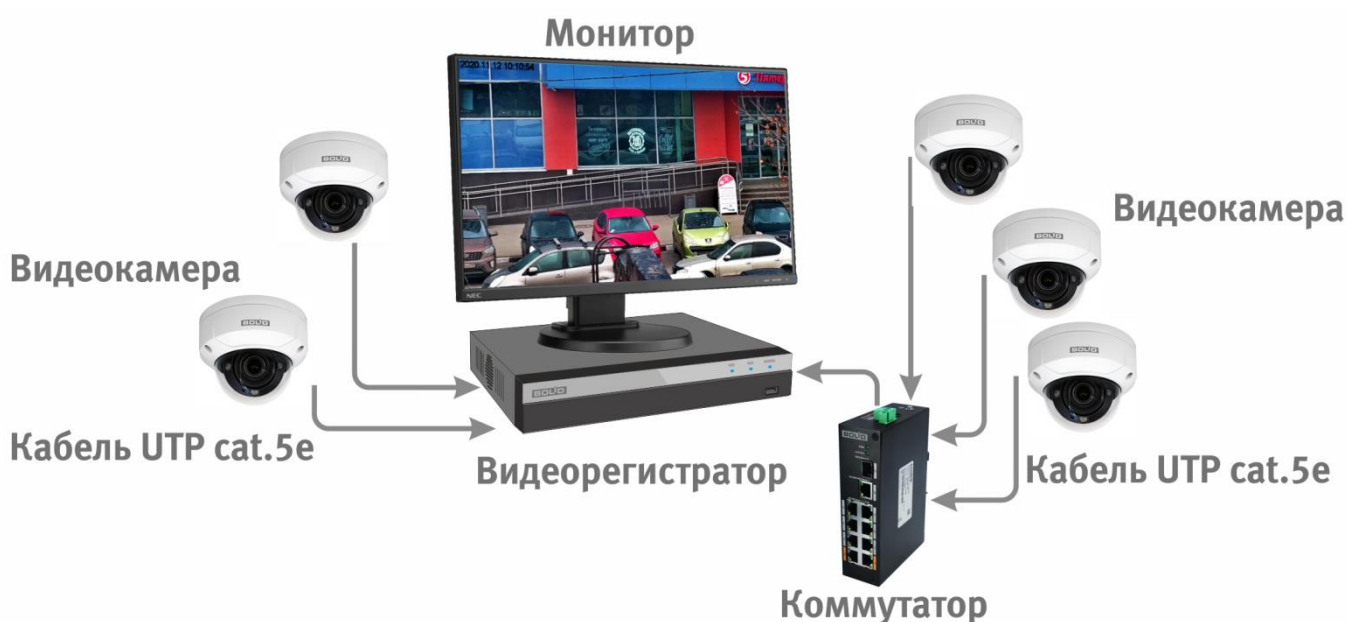
Рисунок 6.5 – Схема подключения видеокamеры к видеорегистратору
