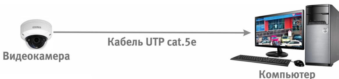
Рисунок 6.3 – Схема подключения видеокамеры к компьютеру
