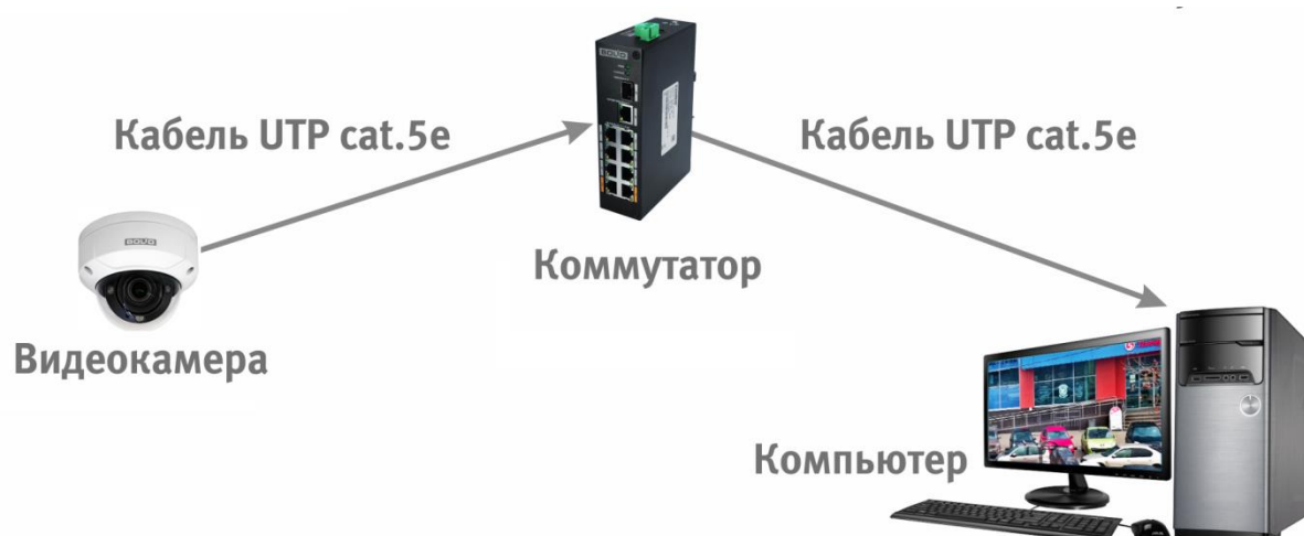
Рисунок 6.4 - Схема подключения видеокамеры к компьютеру через коммутатор
