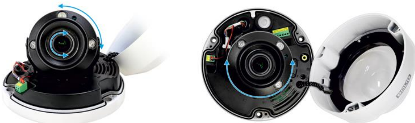
Рисунок 5.16 – Настройка направления объектива
