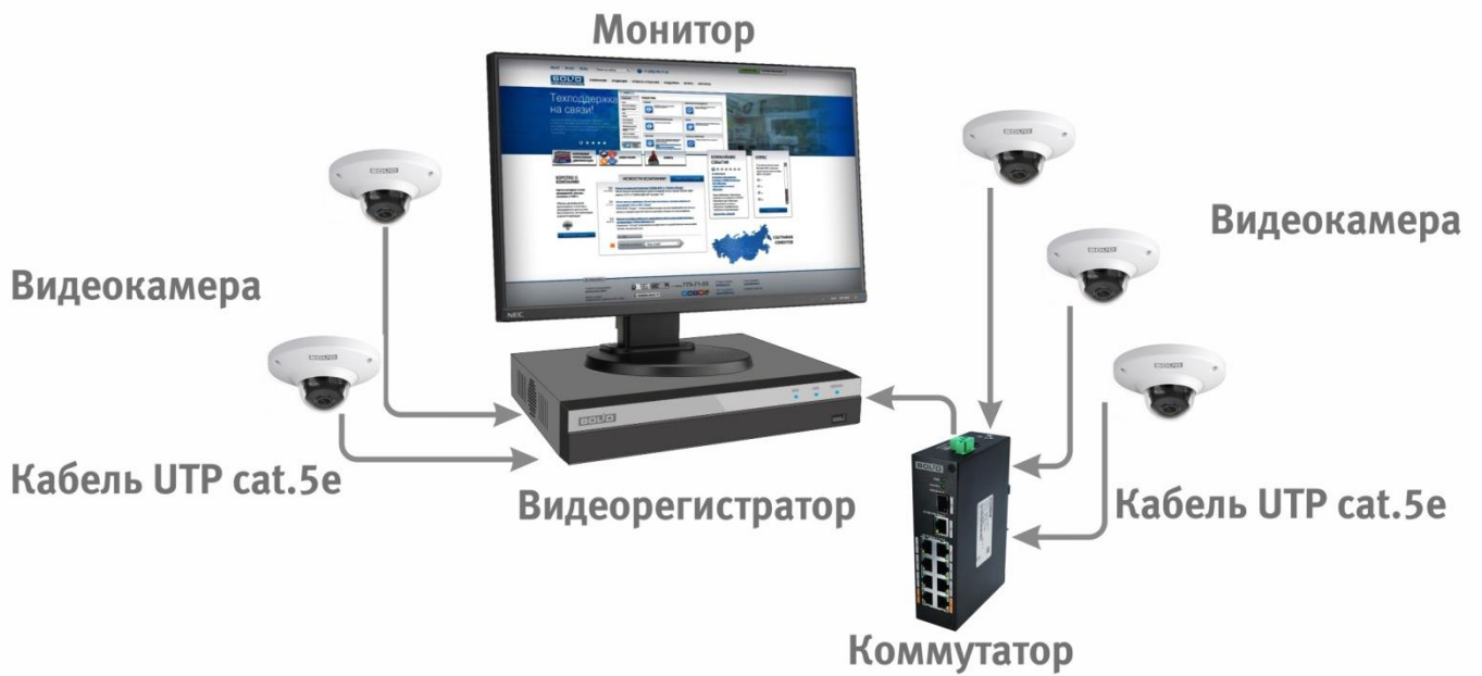
Рисунок 6.4 – Схема подключения видеокамеры к видеорегистратору
