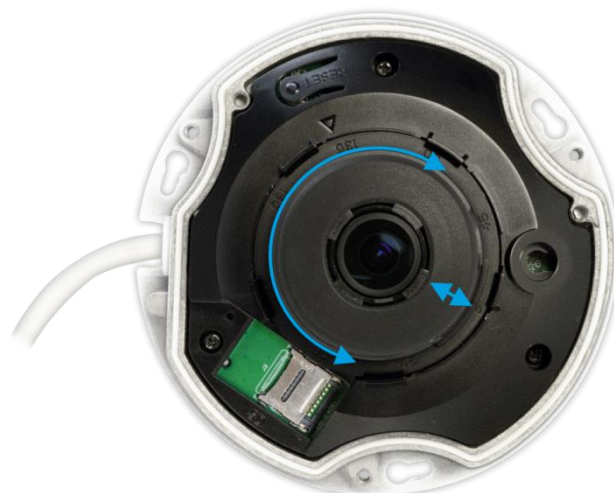
Рисунок 5.4 – Настройка направления объектива
