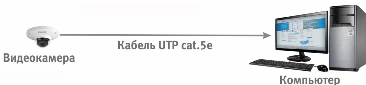
Рисунок 6.2 – Схема подключения видеокамеры к компьютеру
