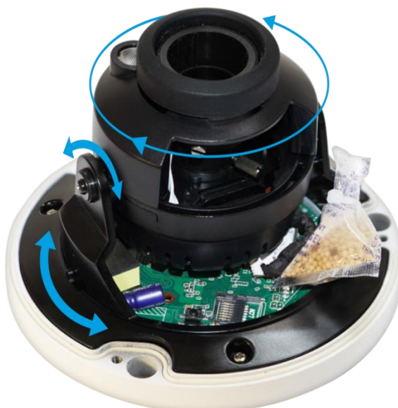
Рисунок 5.12 — Настройка направления объектива
