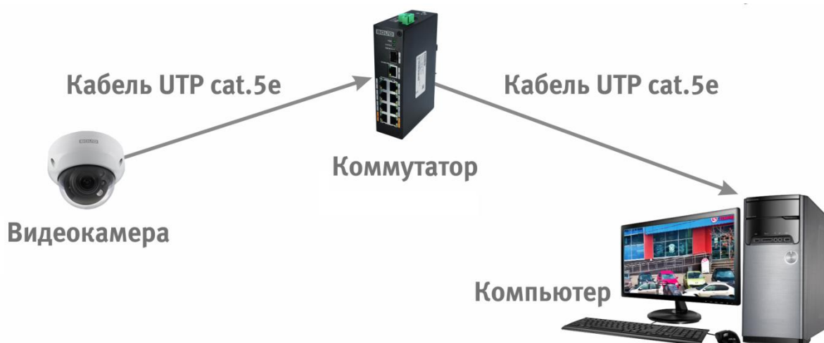
Рисунок 6.3 — Схема подключения видеокамеры к компьютеру через коммутатор
