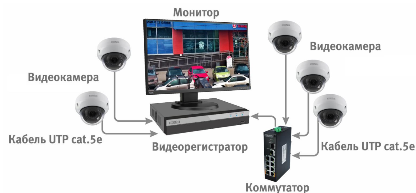
Рисунок 6.4 — Схема подключения видеокamеры к видеорегистратору
