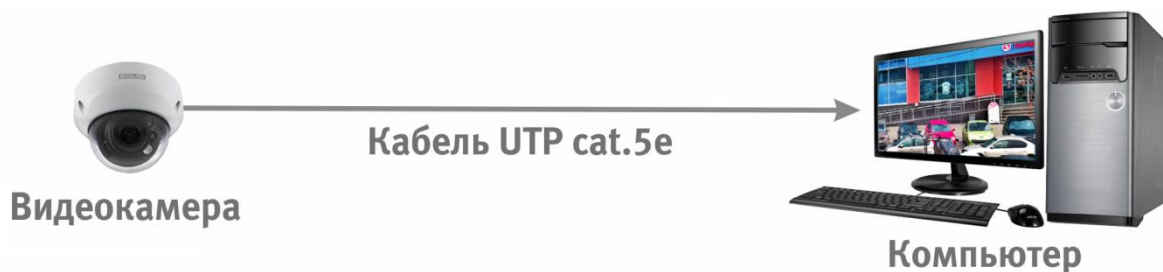
Рисунок 6.2 — Схема подключения видеокамеры к компьютеру
