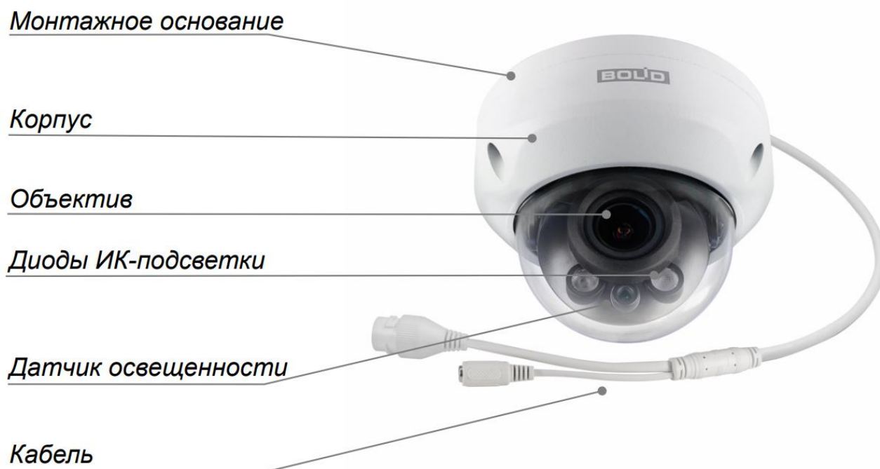
Рисунок 4.1 - Внешний вид и основные элементы видеокамеры
