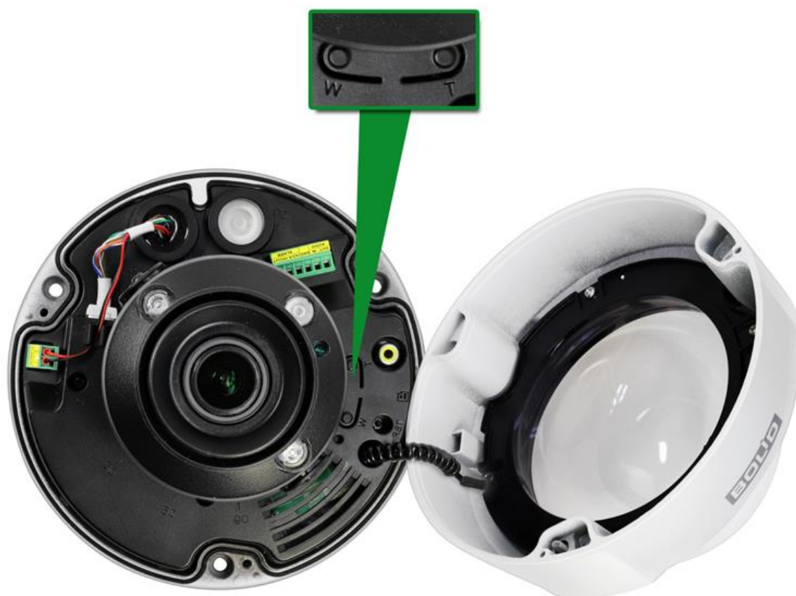
Рисунок 5.15 – Настройка фокусного расстояния вручную
