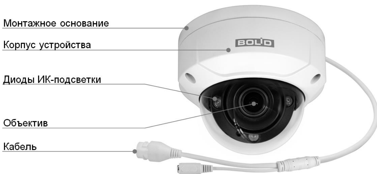
Рисунок 4.1 - Внешний вид и основные элементы видеокамеры
