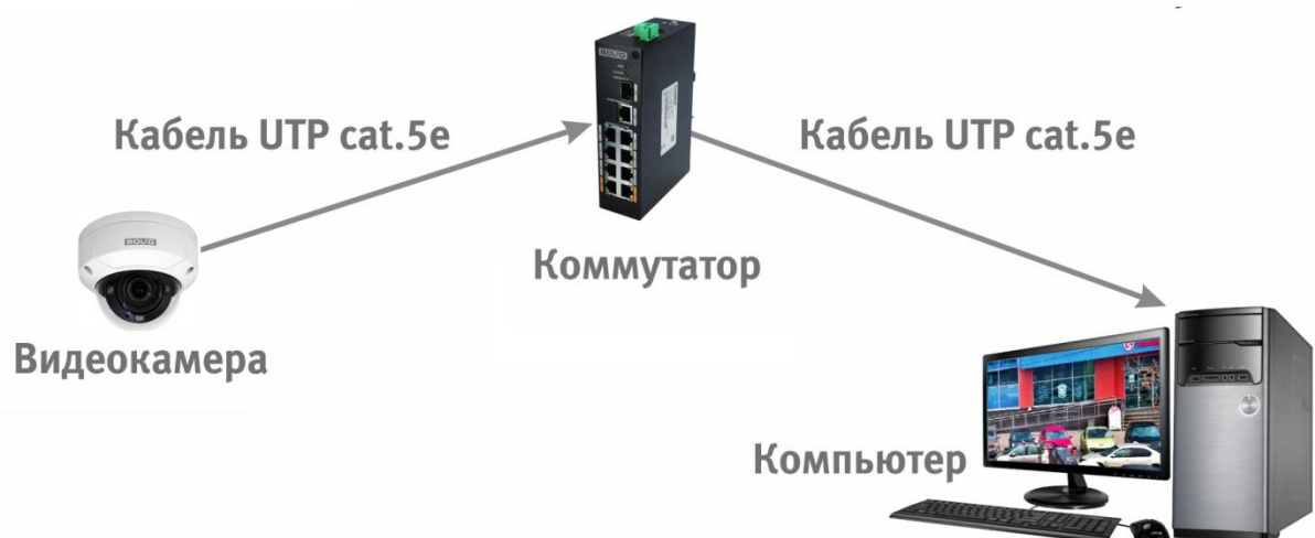
Рисунок 6.4 - Схема подключения видеокамеры к компьютеру через коммутатор
