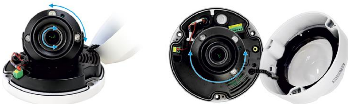
Рисунок 5.16 – Настройка направления объектива
