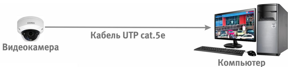
Рисунок 6.3 – Схема подключения видеокамеры к компьютеру
