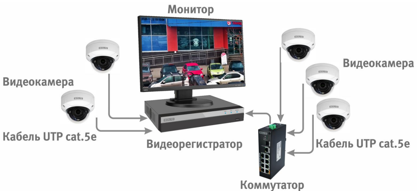
Рисунок 6.5 – Схема подключения видеокамеры к видеорегистратору
