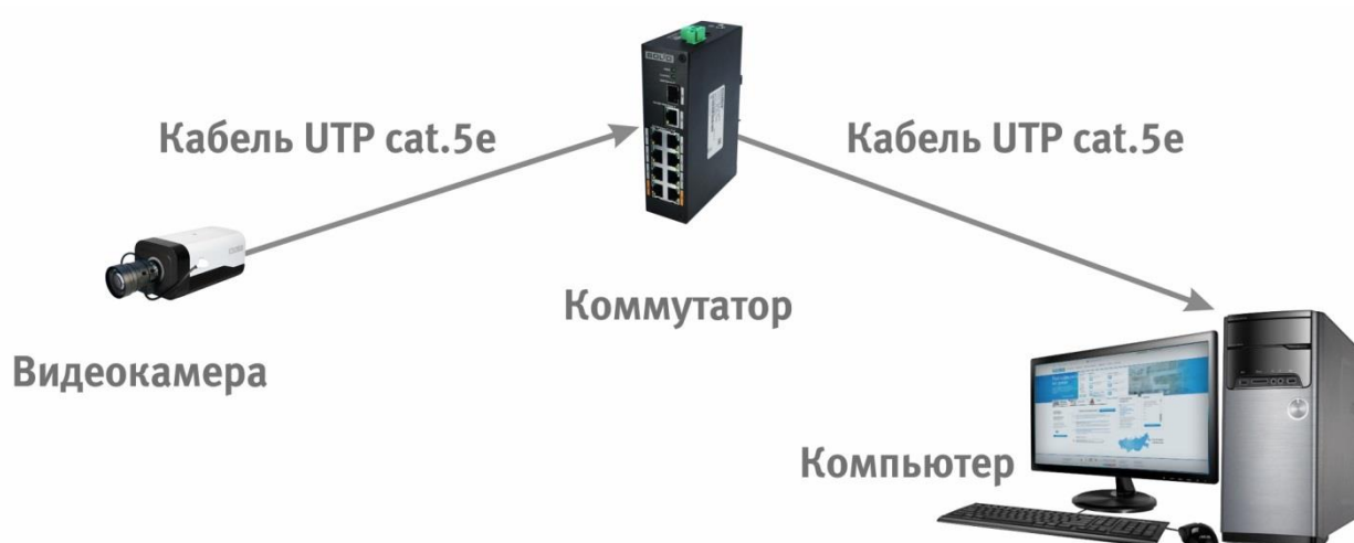
Рисунок 8.3 - Схема подключения видеокамеры к компьютеру через коммутатор
