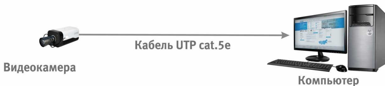
Рисунок 8.2 – Схема подключения видеокамеры к компьютеру
