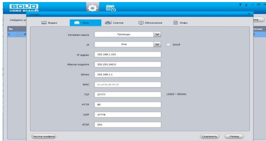
Рисунок 14.2 – Изменение IP-адреса видеокамеры с помощью утилиты «BOLID VideoScan»
