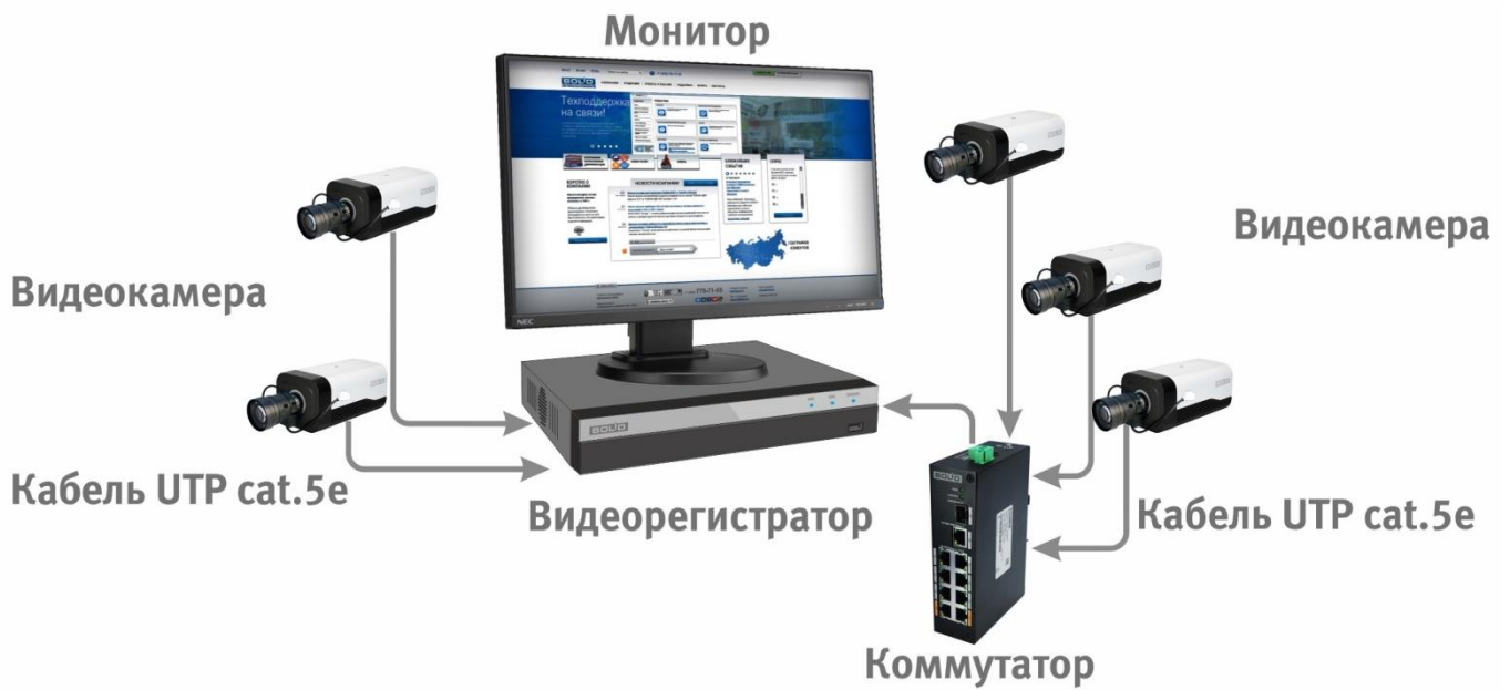
Рисунок 8.4 – Схема подключения видеокамеры к видеорегистратору
