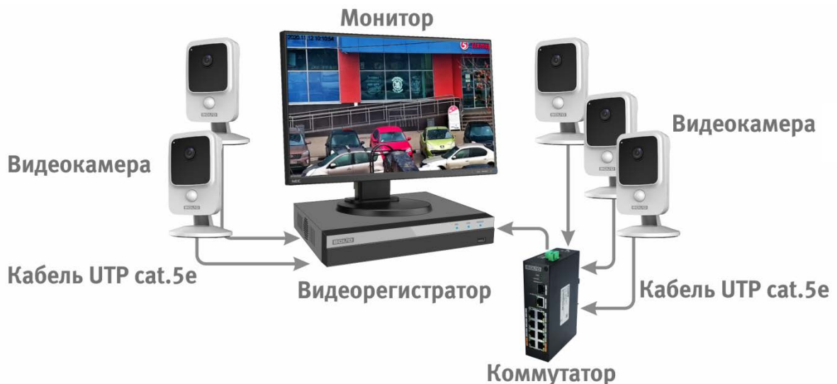
Рисунок 6.5 — Схема подключения видеокamеры к видеорегистратору
