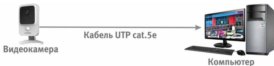
Рисунок 6.2 — Схема подключения видеокамеры к компьютеру
