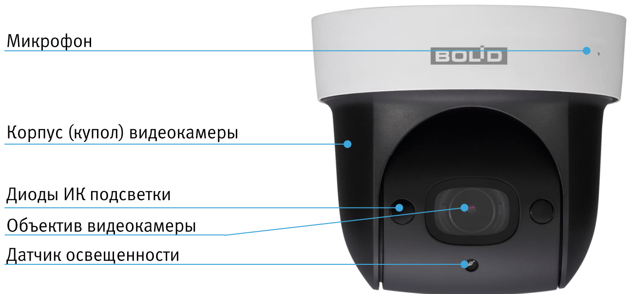
Рисунок 4.1 – Внешний вид и основные элементы видеокамеры
