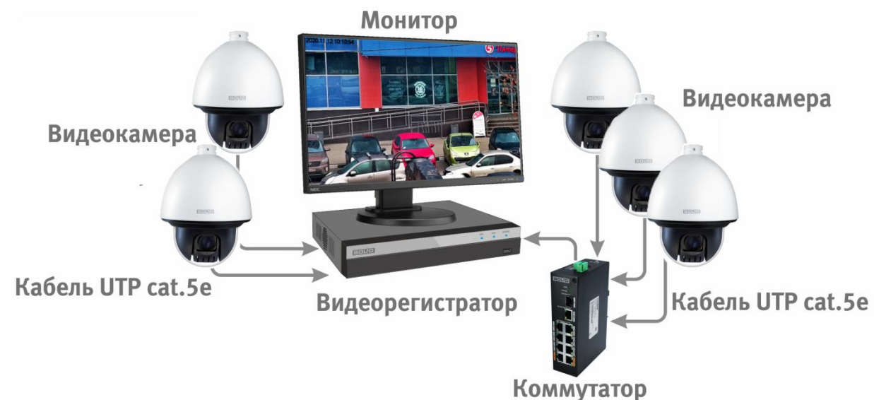
Рисунок 6.4 — Схема подключения видеокамеры к видеорегистратору
