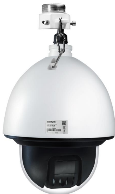
Рисунок 5.4 – Соединение видеокamеры с монтажным адаптером с помощью карабина
