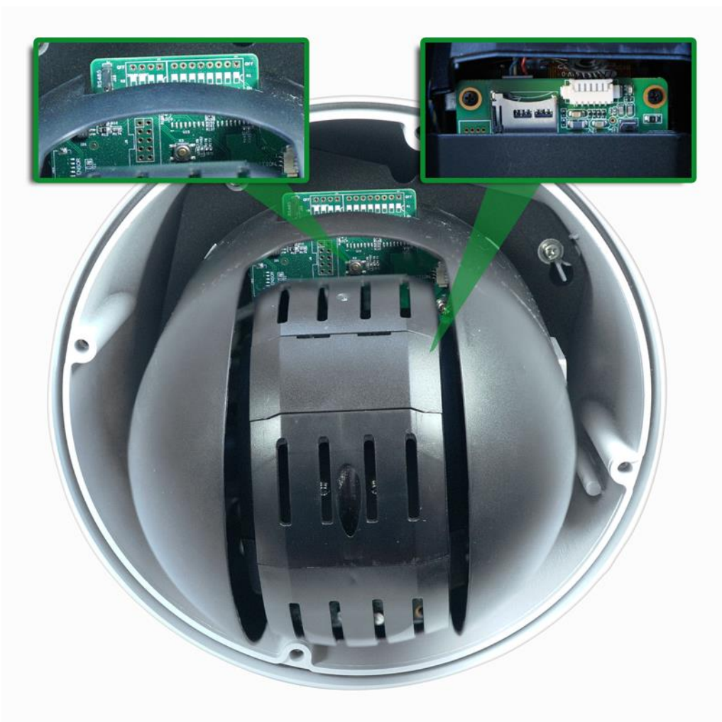
Рисунок 4.2 — Расположение слота для карты памяти и кнопки аппаратного сброса
