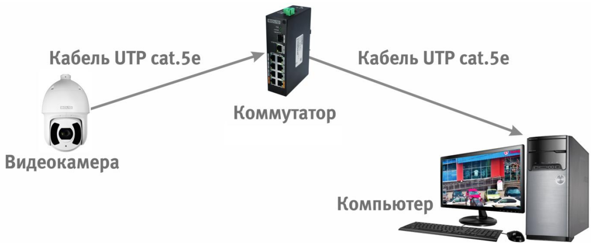
Рисунок 6.3 — Схема подключения видеокамеры к компьютеру через коммутатор
