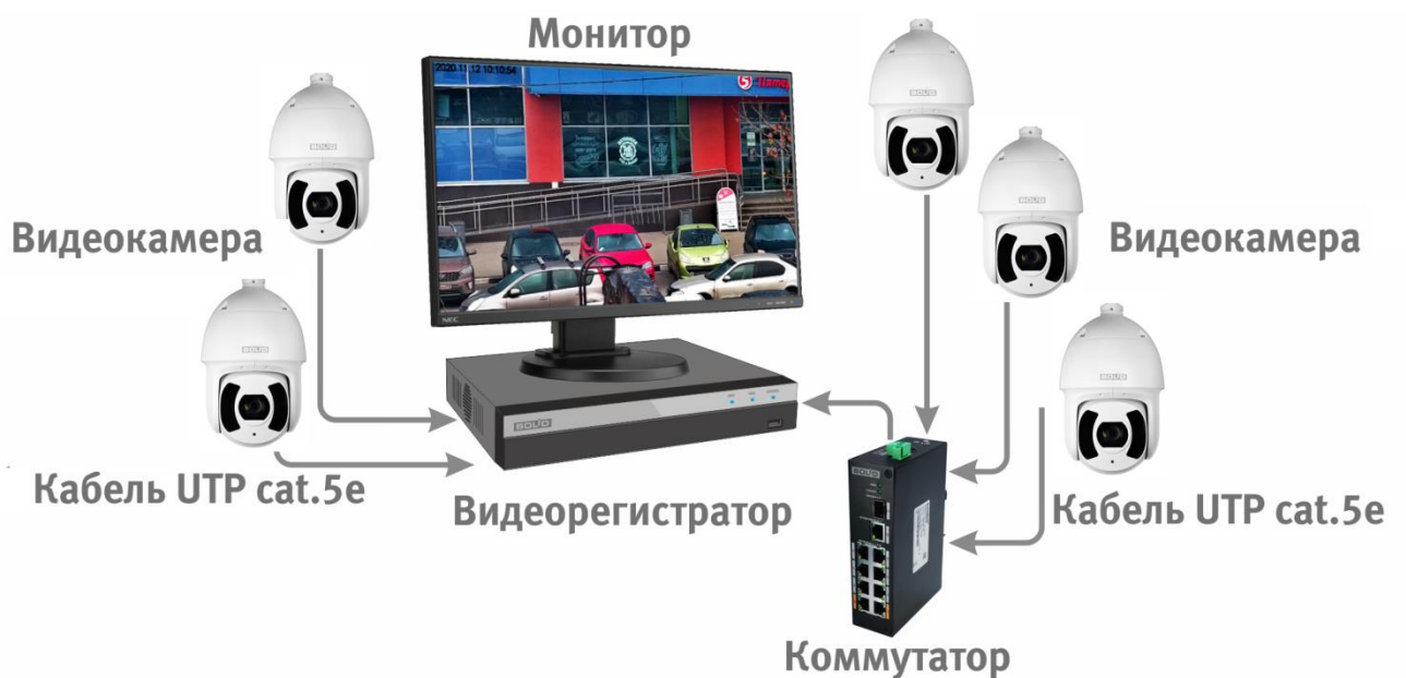
Рисунок 6.4 — Схема подключения видеокамеры к видеорегистратору
