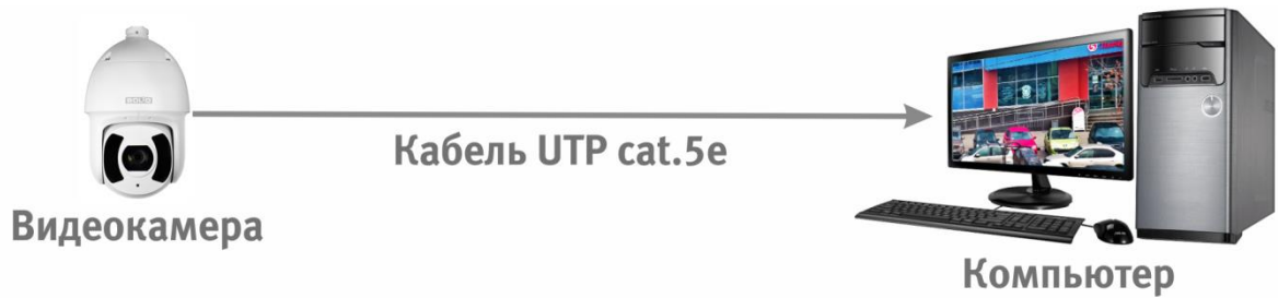
Рисунок 6.2 — Схема подключения видеокамеры к компьютеру
