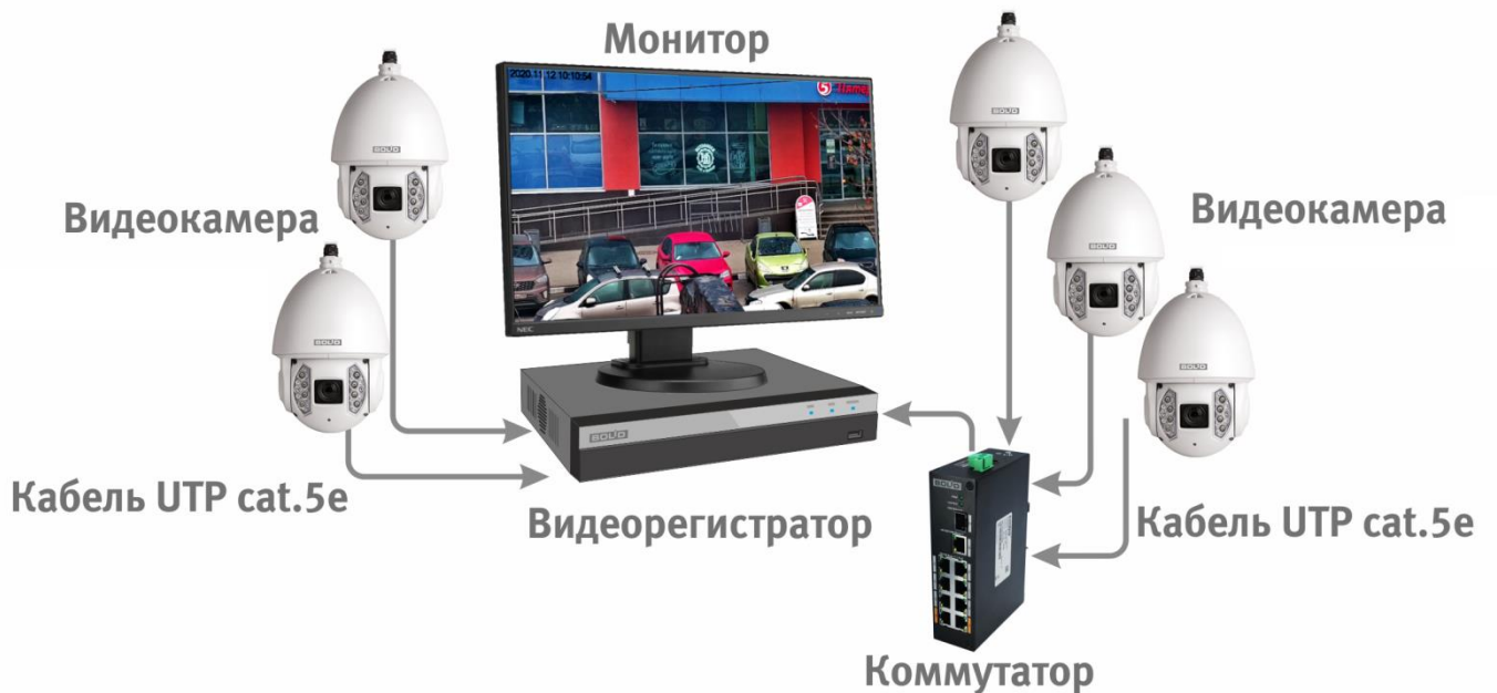
Рисунок 6.4 — Схема подключения видеокамеры к видеорегистратору
