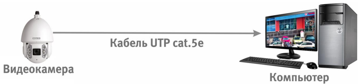
Рисунок 6.2 — Схема подключения видеокамеры к компьютеру
