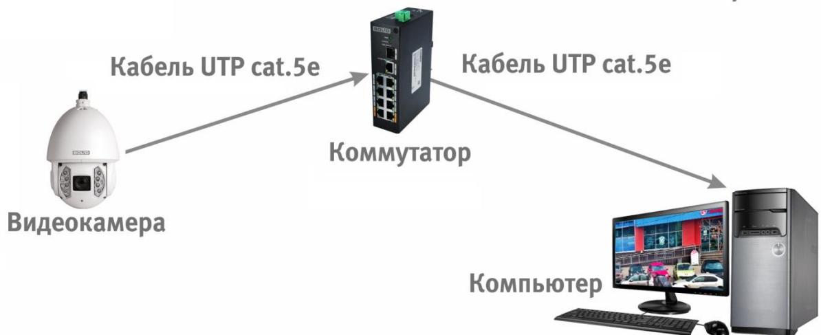
Рисунок 6.3 — Схема подключения видеокамеры к компьютеру через коммутатор
