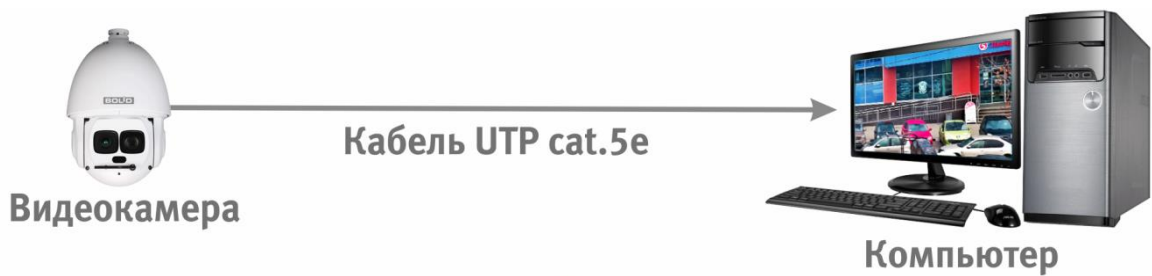
Рисунок 6.2 — Схема подключения видеокамеры к компьютеру
