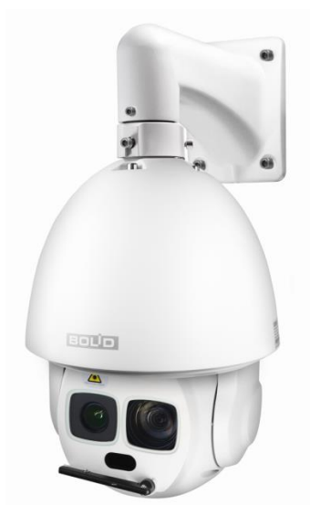
Рисунок 5.7 — Монтаж видеокамеры на настенном кронштейне
