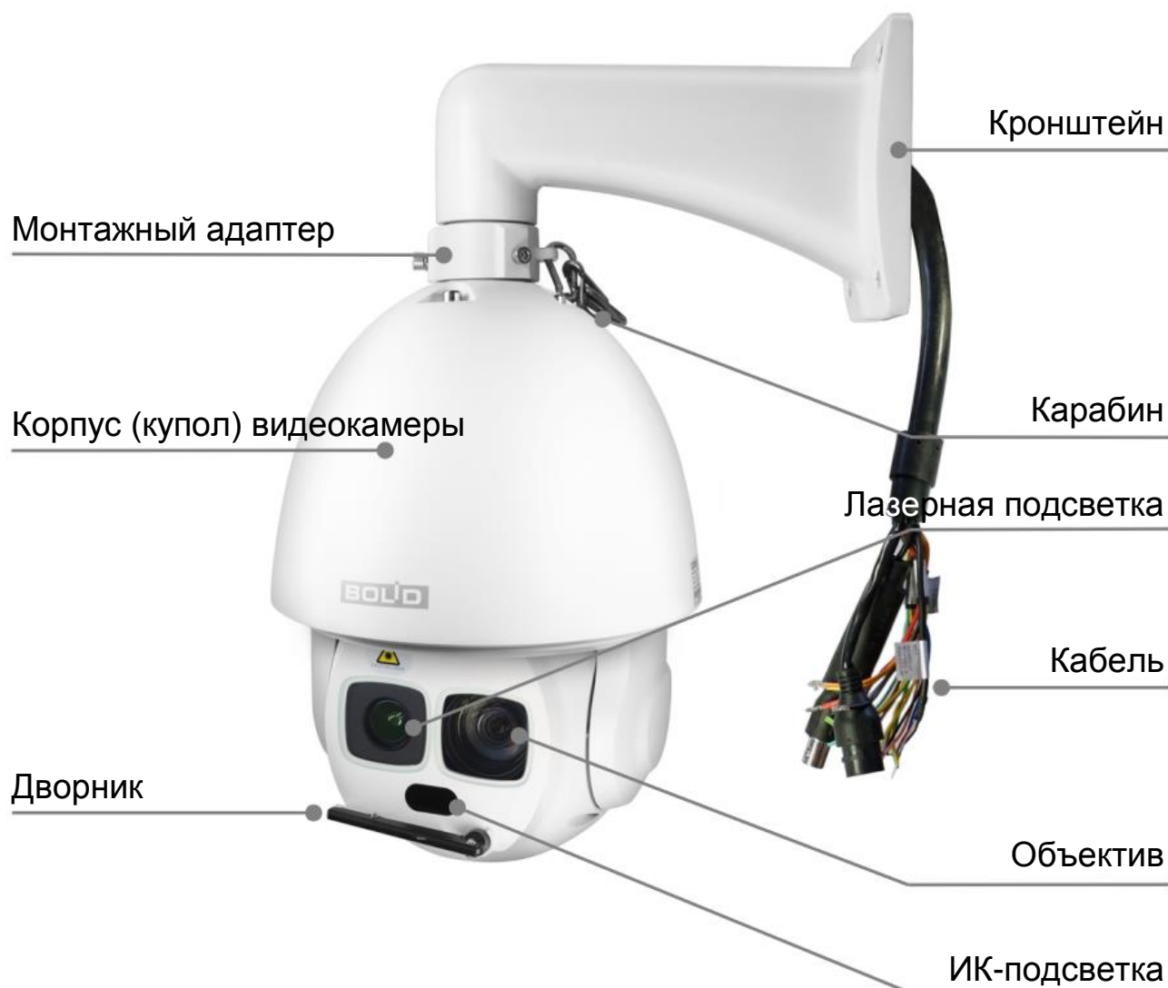
Рисунок 4.1 — Внешний вид и основные элементы видеокамеры
