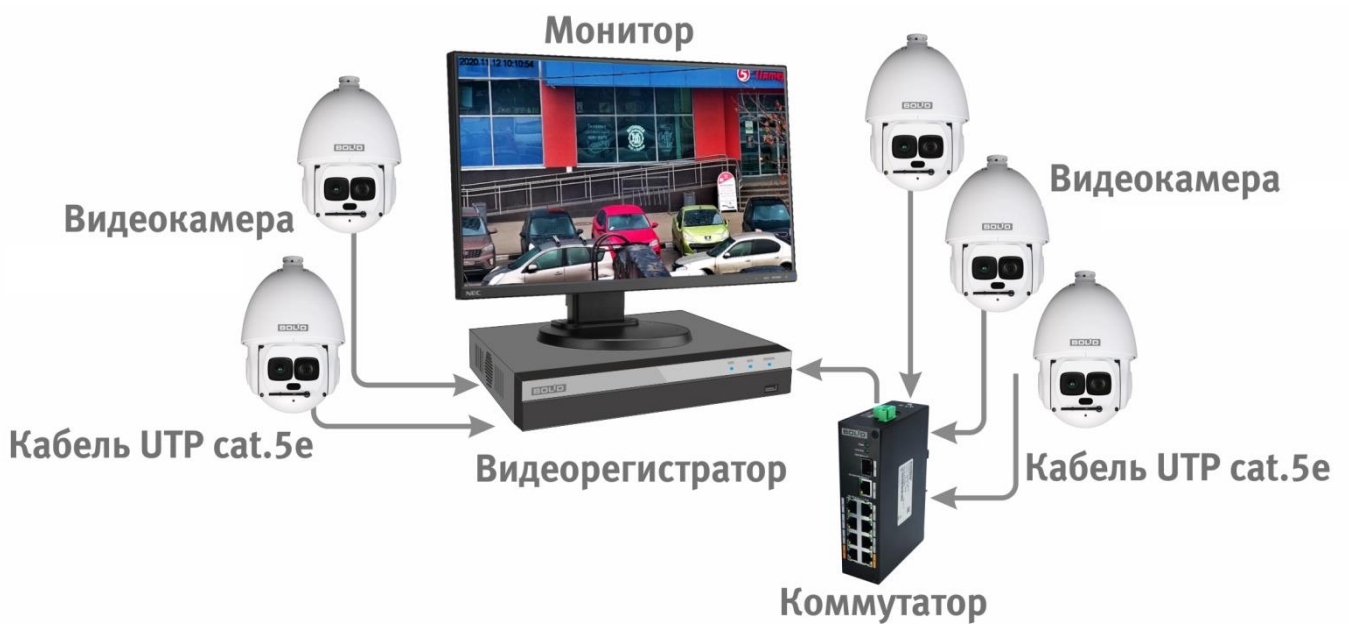
Рисунок 6.4 — Схема подключения видеокамеры к видеорегистратору
