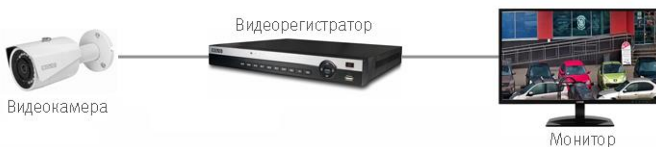
Рисунок 6.2 — Схема подключения видеокамеры
