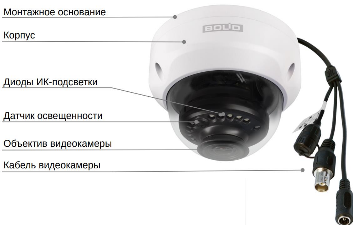
Рисунок 4.1 — Внешний вид и основные элементы видеокамеры
