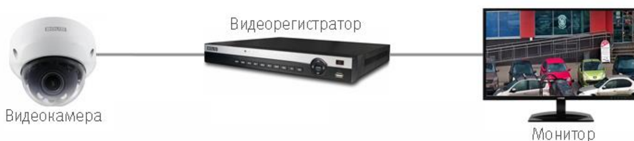
Рисунок 5.2 — Схема подключения видеокамеры
