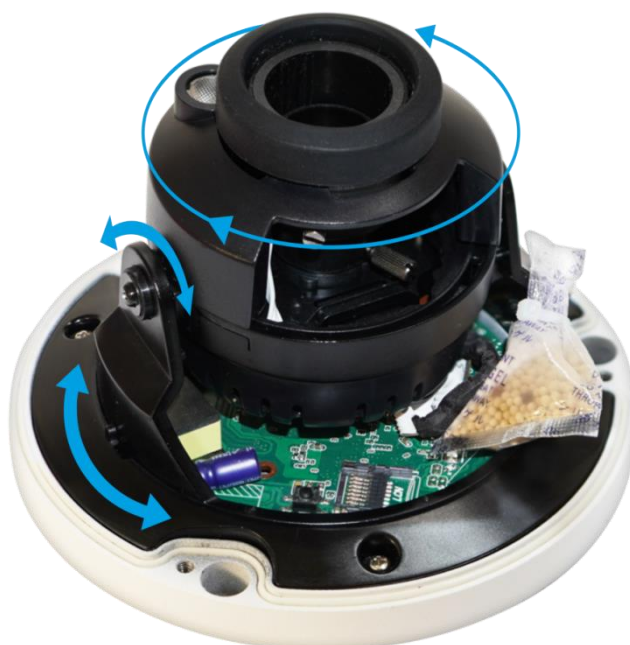
Рисунок 5.5 — Настройка направления объектива
