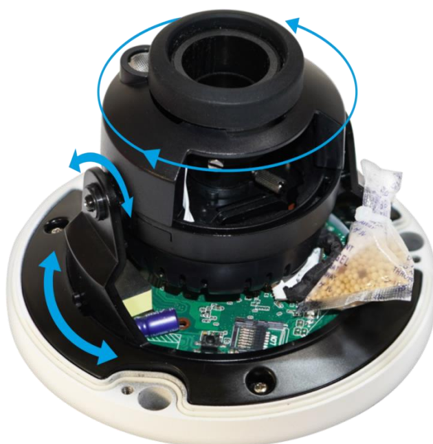
Рисунок 6.5 — Настройка направления объектива
