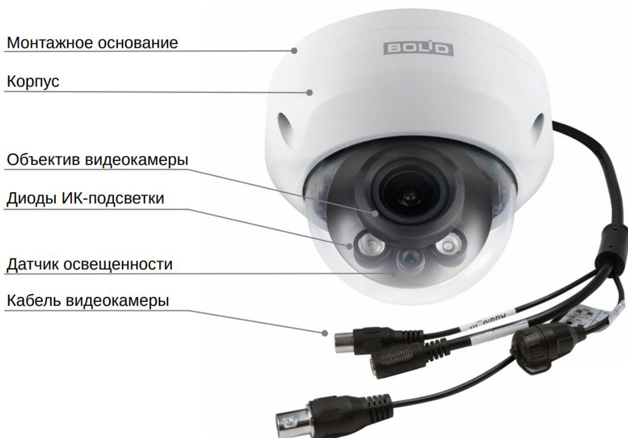
Рисунок 4.1 — Внешний вид и основные элементы видеокамеры
