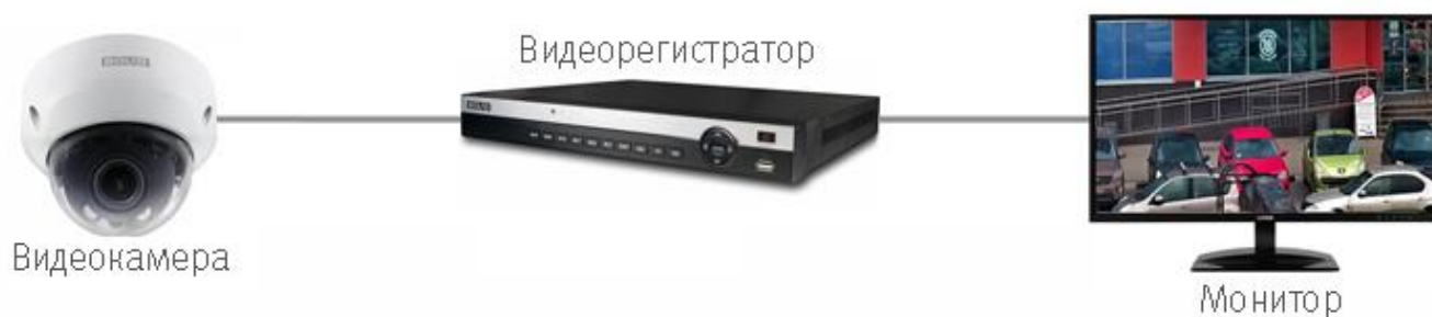
Рисунок 6.2 — Схема подключения видеокamеры
