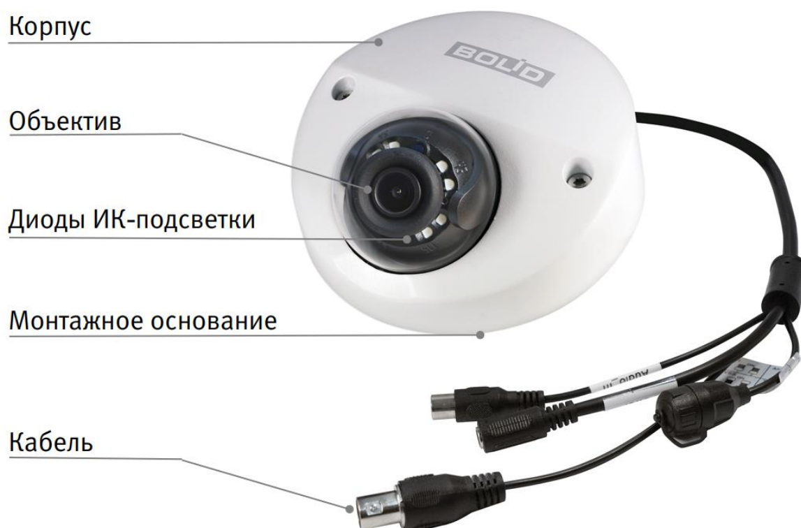
Рисунок 4.1 — Внешний вид и основные элементы видеокамеры
