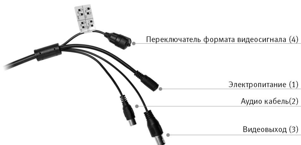
Рисунок 6.1 — Концевая раскладка кабеля видеочамеры
