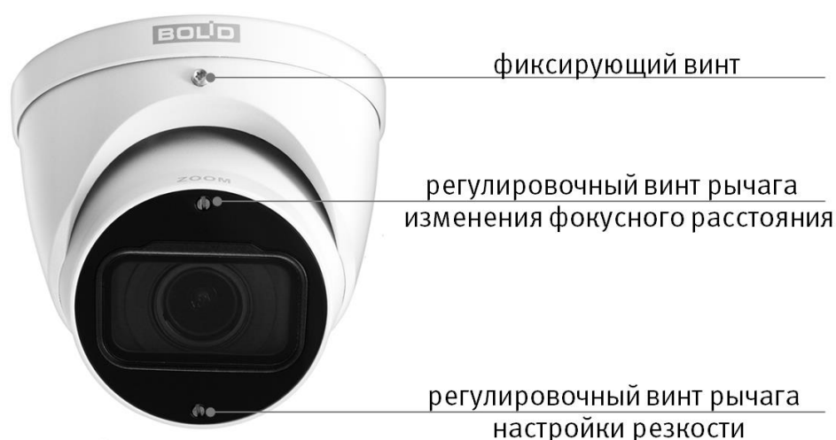
Рисунок 6.4 — Настройка фокусного расстояния и направления объектива
